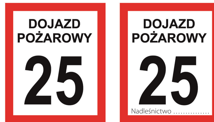
Rycina 2. Oznakowanie dojazdu pożarowego tablicą
