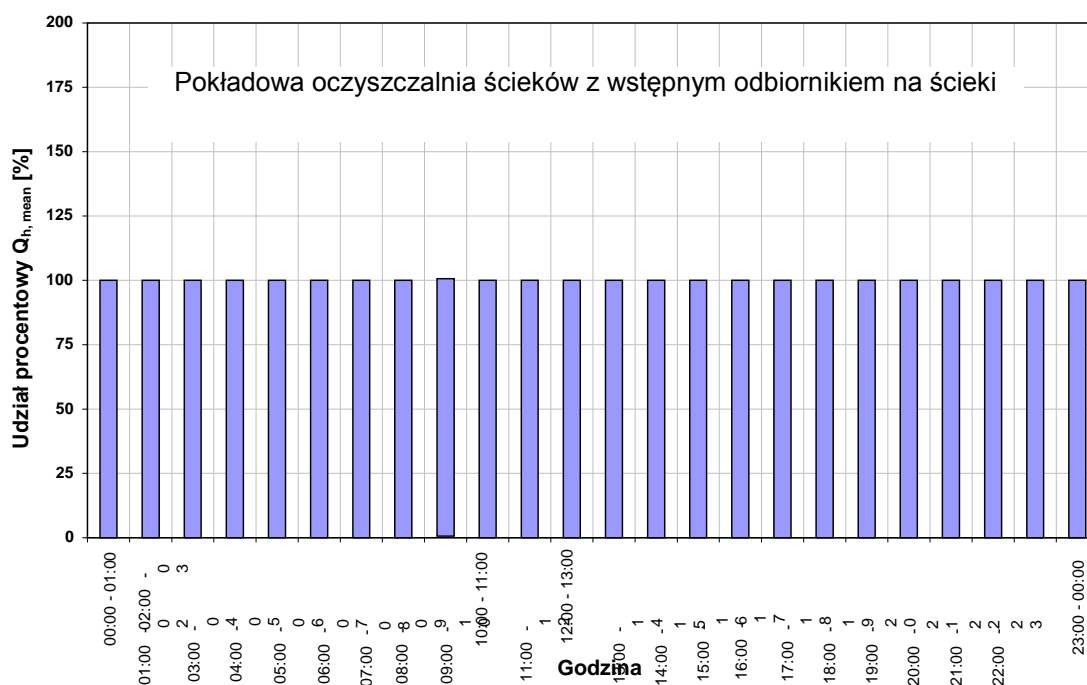
Wykres 1: Dzienny hydrograf zasilania pokładowej oczyszczalni ścieków z wstępnym odbiornikiem na ścieki
