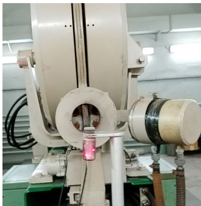
Fot. 3. Wyjście wiązki prostej elektronów przyspieszanej w akceleratorze LAE 13/9. Miejsce umieszczenia próbki badawczej określonej na folii z PCW zaznaczono czerwonym plamką lasera.
