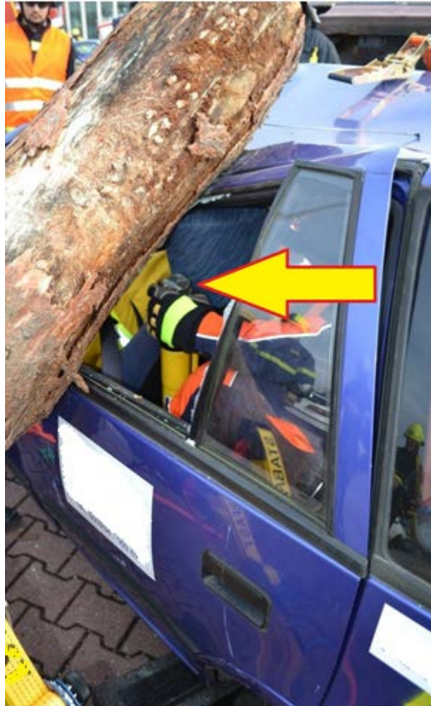
Rys. 322. Przygotowanie do techniki cross-ramming w miejscu zgniotu
