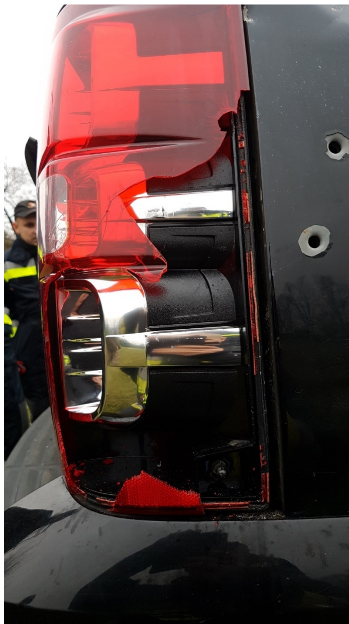
Rys. 459. Łatwy demontaż tylnego klosza w celu uzyskania szczeliny do wyważenia klapy bagażnika
