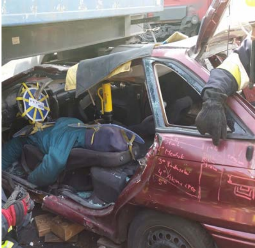
Rys. 360. Uzyskanie dostępu poprzez usunięcie całego boku pojazdu
