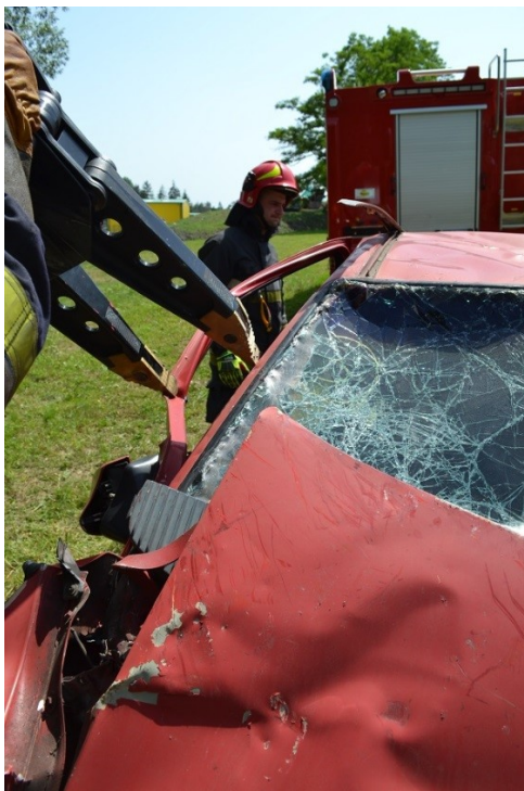
Rys. 438. Odgięcie ramek drzwi przednich w celu uzyskania szczeliny do przełożenia łańcuchów
