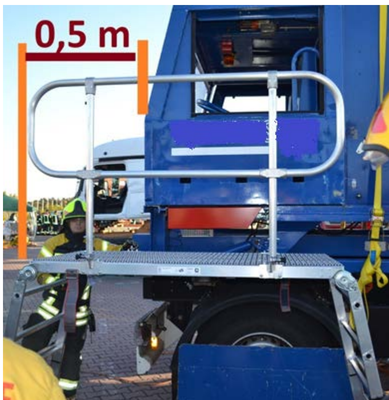
Rys. 335. Odpowiednie wysunięcie podestu poza przedni obrys kabiny
