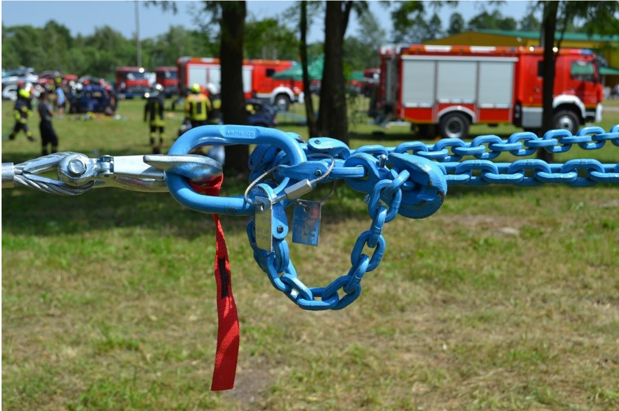
Rys. 437. Zastosowanie łańcuchów, które umożliwiają regulację ich długości
