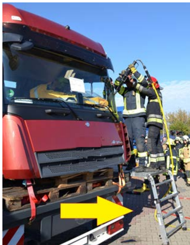
Rys. 336. Odpowiednie wysunięcie poza przedni obrys ułatwia późniejszy dostęp z platformy do zawiasów pojazdu
