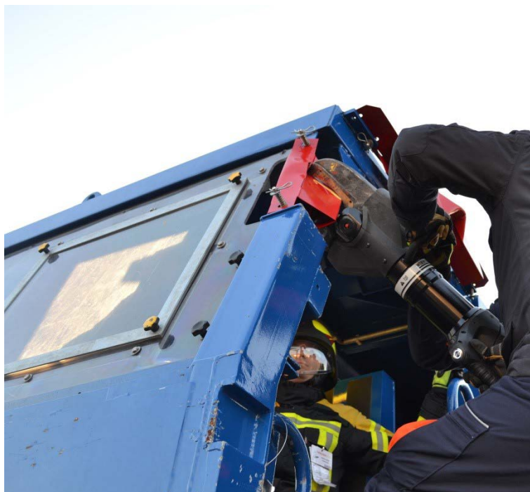
Rys. 341. Nacięcie słupka A równoległe do jego przekroju
