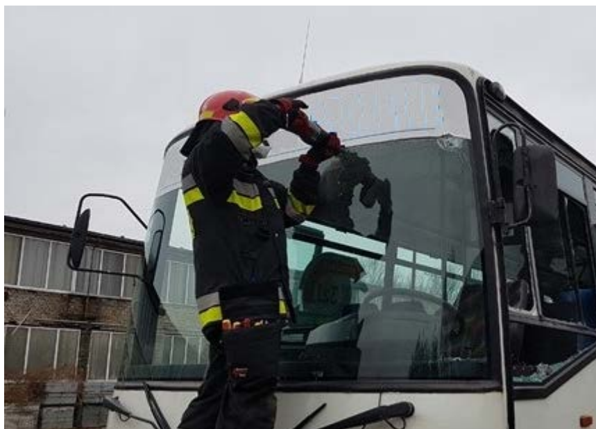
Rys. 398. Cięcie przedniej szyby klejonej przy pomocy piły szablastej
