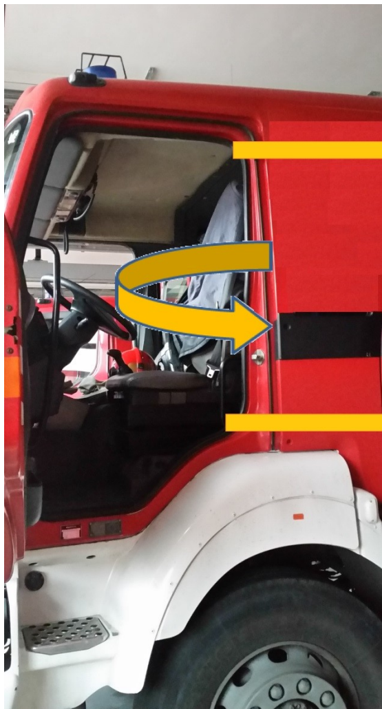
Rys. 347. Zaznaczone miejsca cięcia oraz kierunek odgięcia
