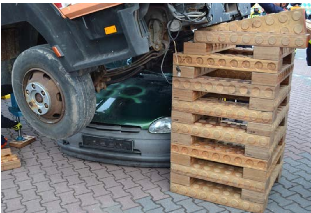
Rys.369. Wysoka podbudowa drewnem
