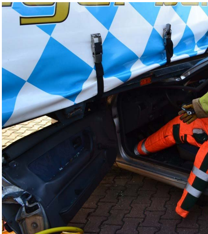
Rys. 359. Szeroki dostęp do poszkodowanego po wyważeniu drzwi i obcięciu ich ramek
