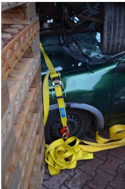
Rys. 370. Spięcie resorowania samochodu osobowego
