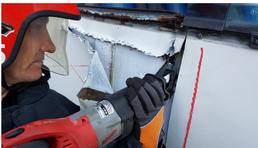
Rys. 406. Cięcie całego boku autobusu piłą szablastą
