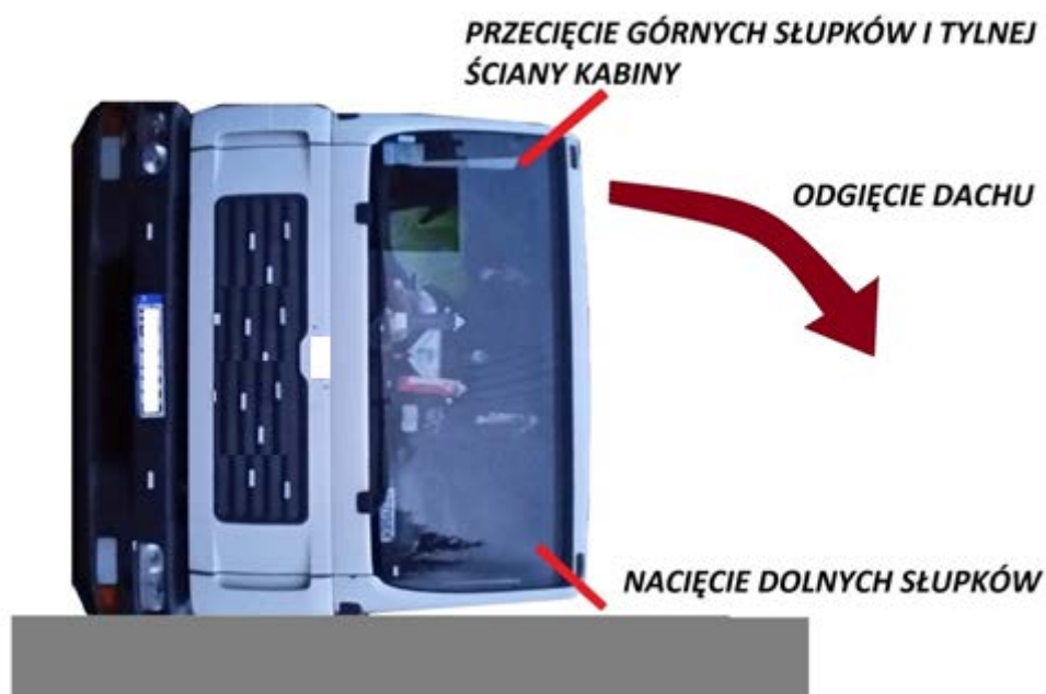
Rys. 353. Miejsca wykonywania cięć w technice odcięcia dachu
