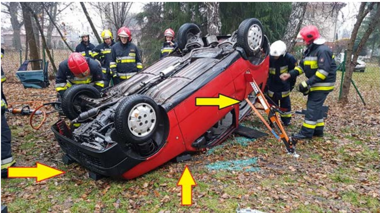
Rys. 309. Widoczna stabilizacja klinami w osi pojazdu, podbudowa w okolicach słupka A oraz wysoko umiejscowiony punkt mocowania pasa podpory szybkiej stabilizacji
