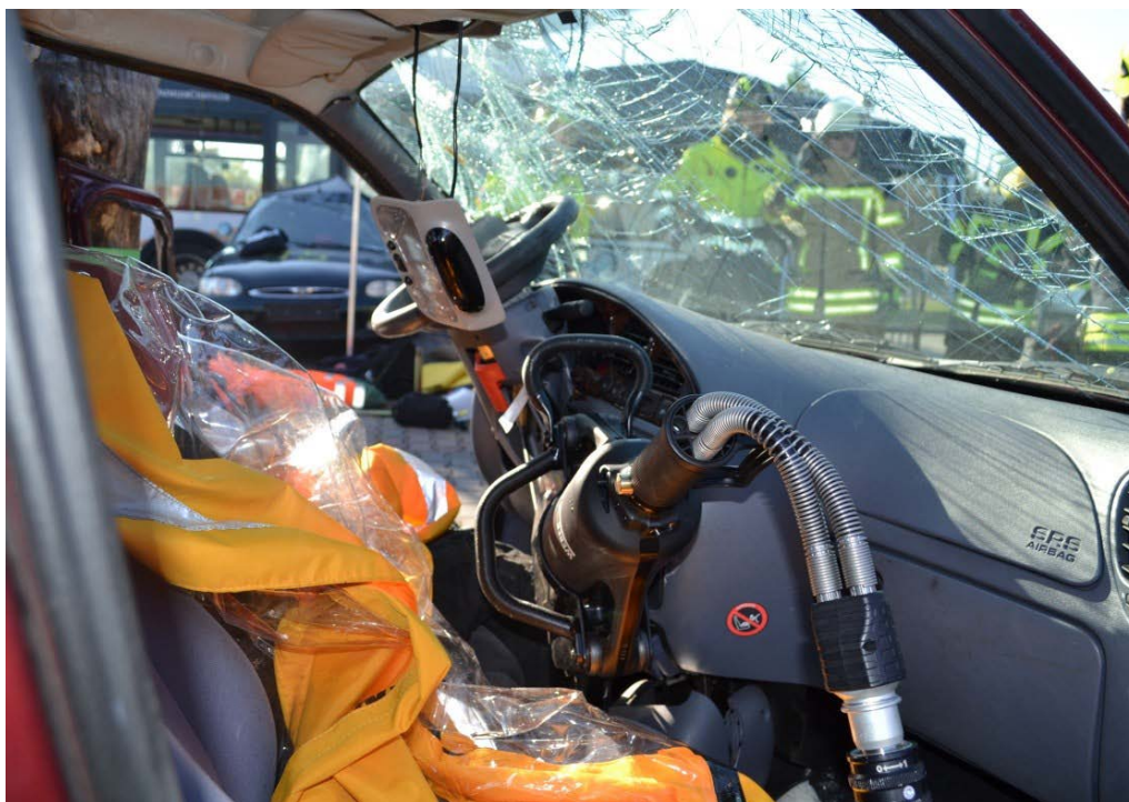
Rys. 326. Uniesienie kolumny kierownicy od strony nieuszkodzonej
