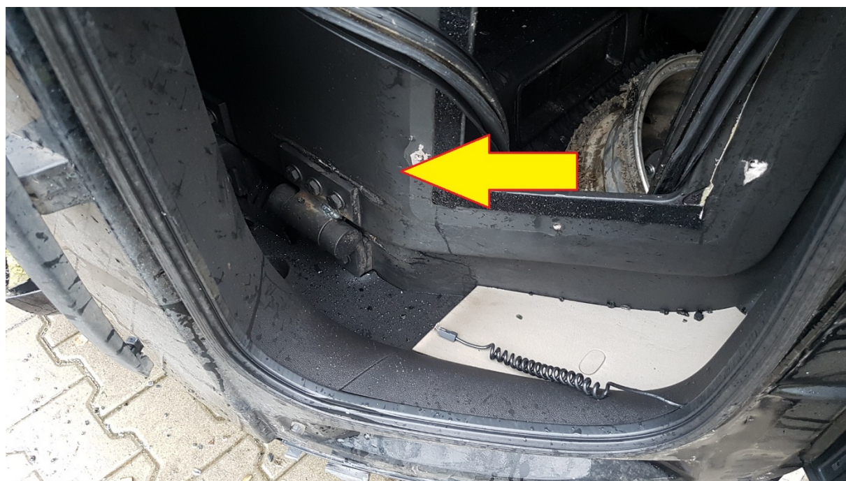
Rys. 454. Stalowe drzwi pod tylną klapą (samochód w pozycji na boku)
