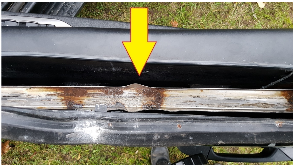
Rys. 447. Stalowe wzmocnienie w drzwiach
