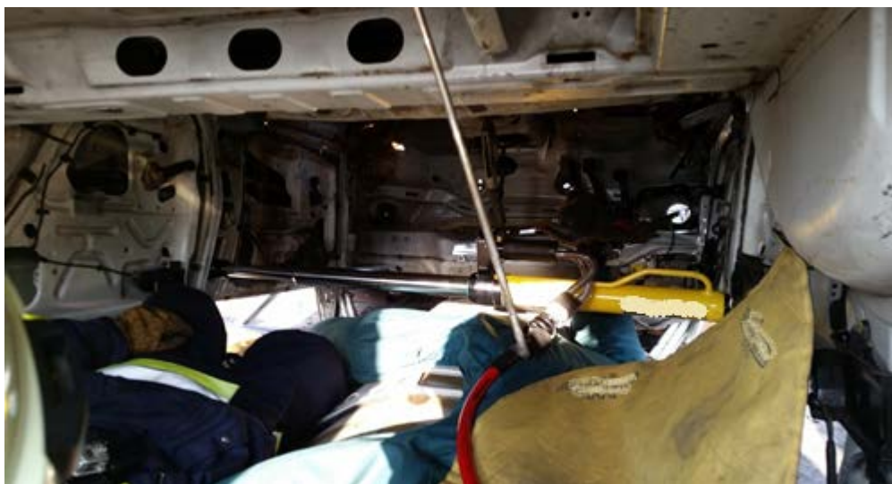
Rys. 307. Technika cross-ramming w pojeździe na dachu
