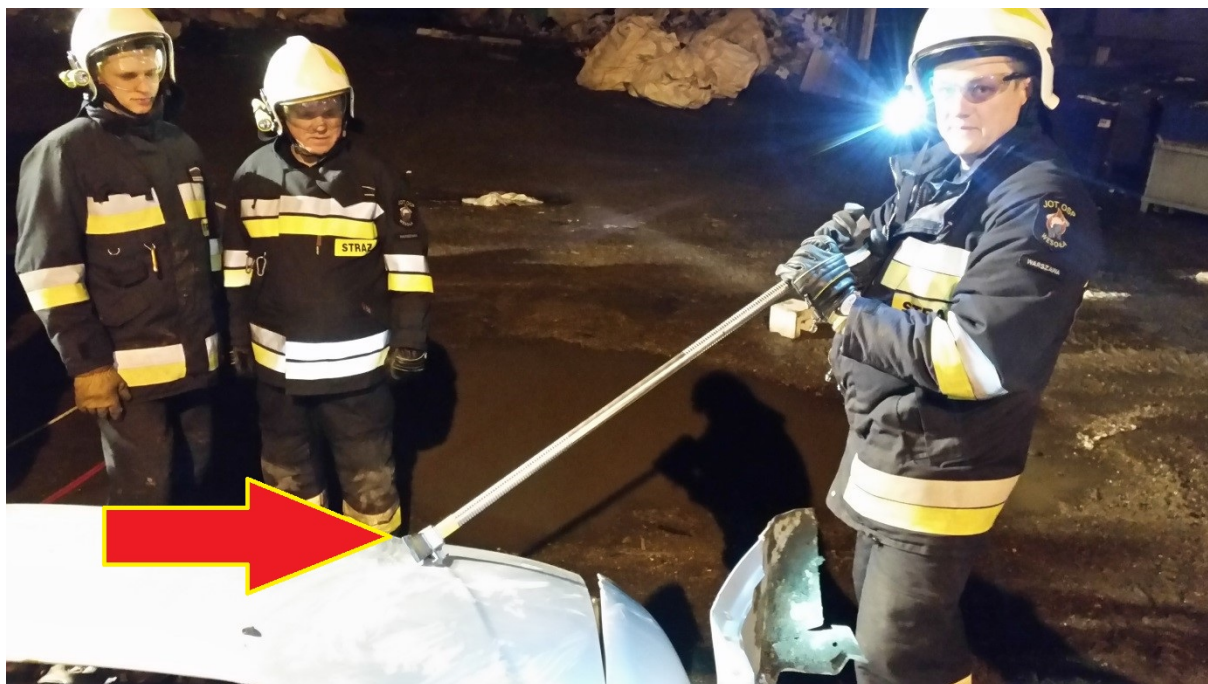
Rys. 330. Wbicie kolca halligana w okolice krawędzi maski
