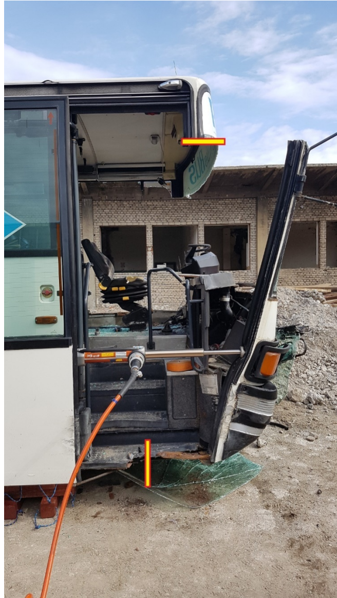
Rys. 412. Odepchnięcie przodu pojazdu przy pomocy cylindra rozpierającego
