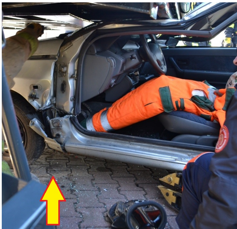
Rys. 362. Metoda amerykańska: brak stabilizacji pod słupkiem B. Widoczne nacięcie podstawy słupka B, równoległe do ziemi
