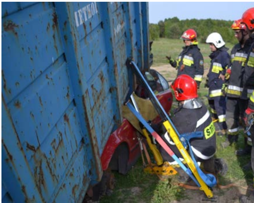
Rys. 365. Stabilizacja boczna kontenera i jego wstępne unoszenie cylindrami rozpierczającymi, osadzonymi na wspornikach progowych, połączonych pasem transportowym
