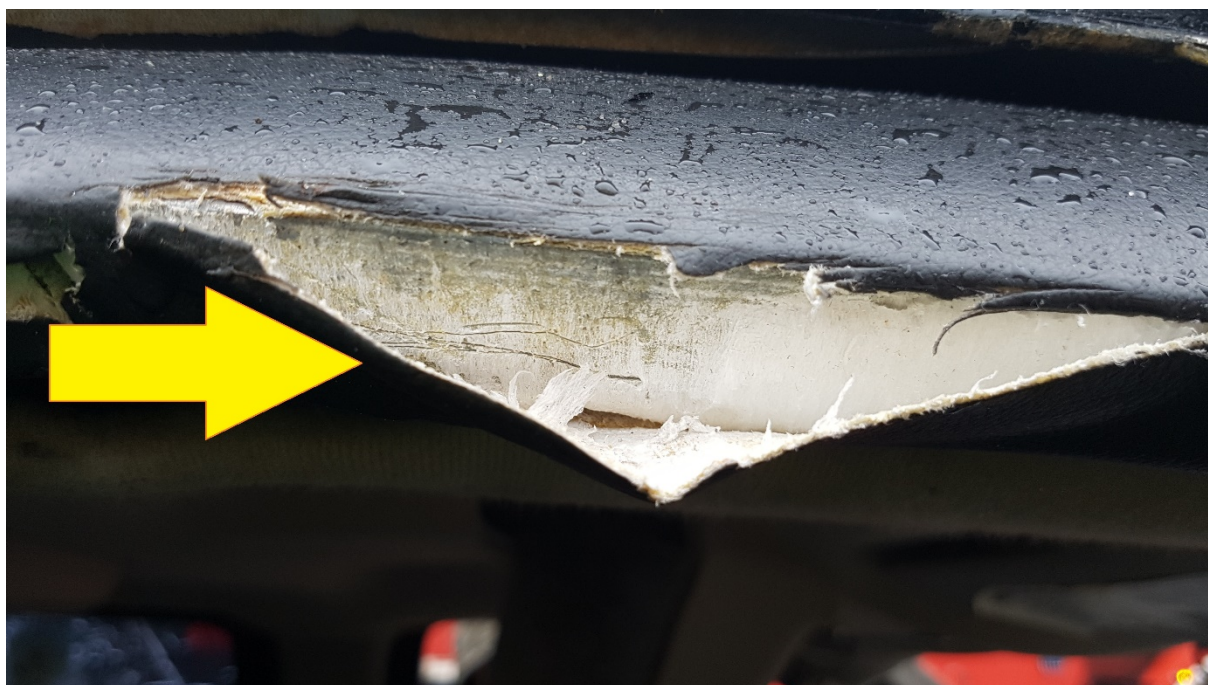
Rys. 450. Wewnętrzny szkielet balistyczny. Strefa podsufitowa
