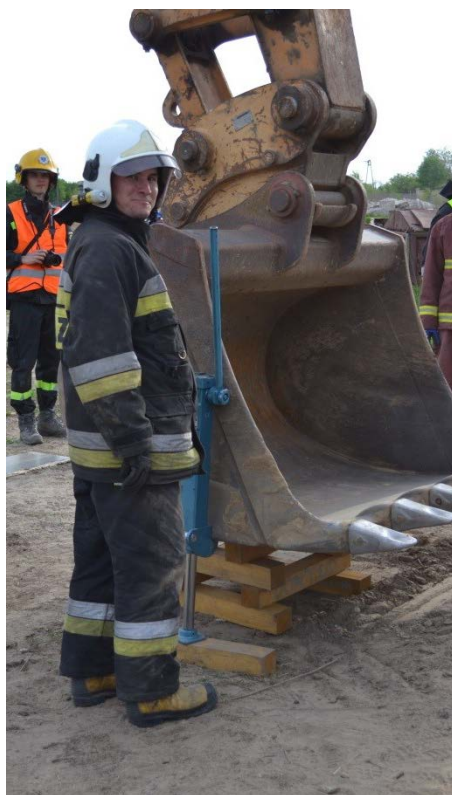
Rys. 390. Podbudowa łyżki drewnem
