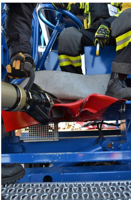
Rys. 342. Nacięcie w V po uprzednim zgnieciu dolnej części kabiny przy pomocy rozpieracza
