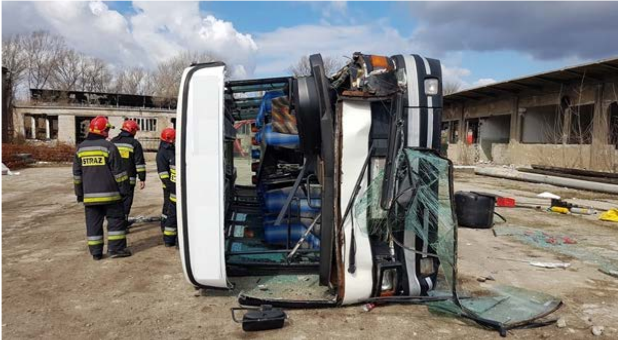
Rys. 417. Dostęp do wnętrza przez przednią szybę
