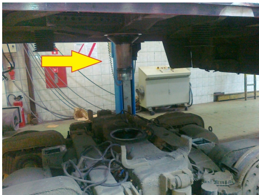
Rys. 427. Gniazdo wózka jezdnego i sworzeń wagonu Źródło: Jacek Gawroński, SA PSP Poznań
