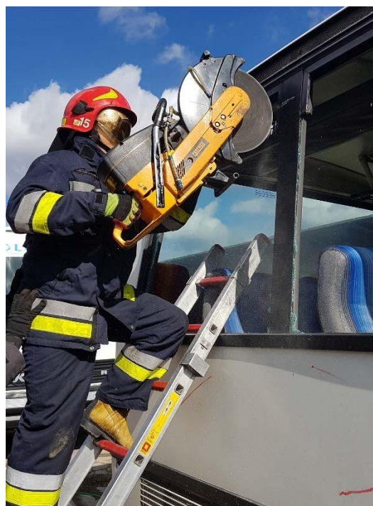
Rys. 410. Wykorzystanie piły spalinowej z tarczą korundową
