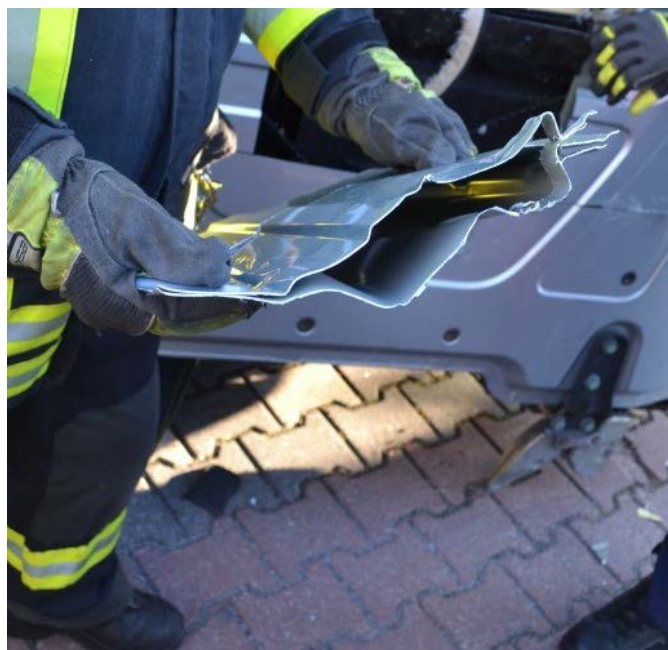
Rys. 350. Przekrój przez wypukłe elementy ściany kabiny
