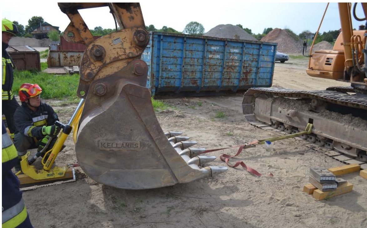
Rys. 389. Pchanie łyżki koparki. Tu widoczne ustabilizowanie pasem transportowym, zapobiegającym ślizganiu się cylindra rozpierającego
