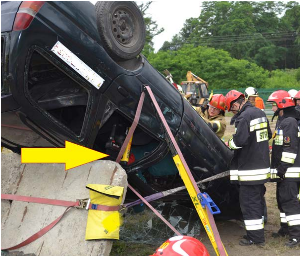
Rys. 313. Stabilizacja przy pomocy długich podpór mechanicznych
