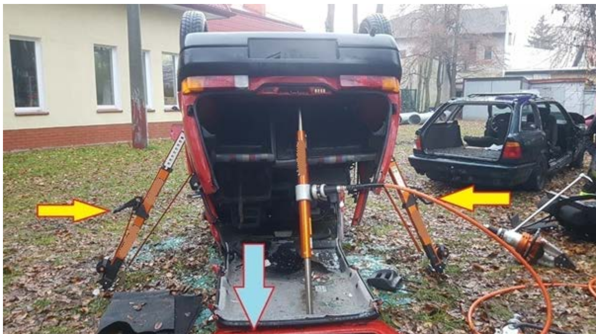
Rys. 311. Stałe naciąganie pasów podczas ruchu dachu w dół. Miejsce wstawienia cylindra rozpierającego nie przeszkadza w późniejszej ewakuacji
