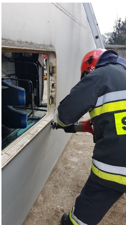
Rys. 419. Bezpieczne poszerzanie otworu piłą szablastą i niebezpieczne spaliniową piłą z tarczą korundową
