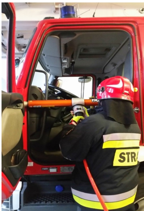
Rys. 340. Ustawienie cylindra rozpierającego przy wypychaniu przodu kabiny (zarówno bez naciąg odprężających, jak i z nimi)
