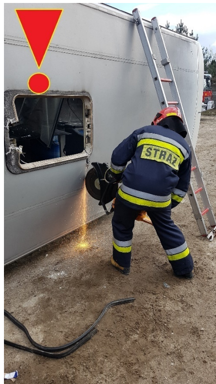
Rys. 419. Bezpieczne poszerzanie otworu piłą szablastą i niebezpieczne spaliniową piłą z tarczą korundową
