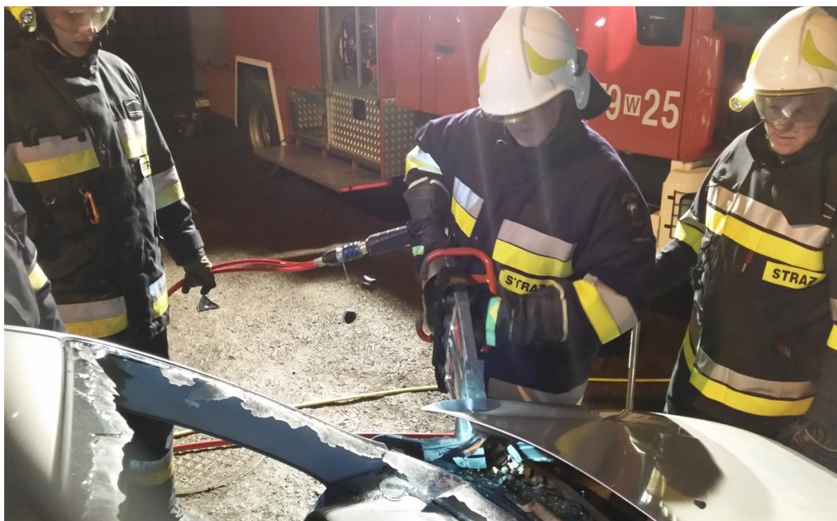
Rys. 328. Wyrwanie zawiasów maski przy pomocy rozpieracza
