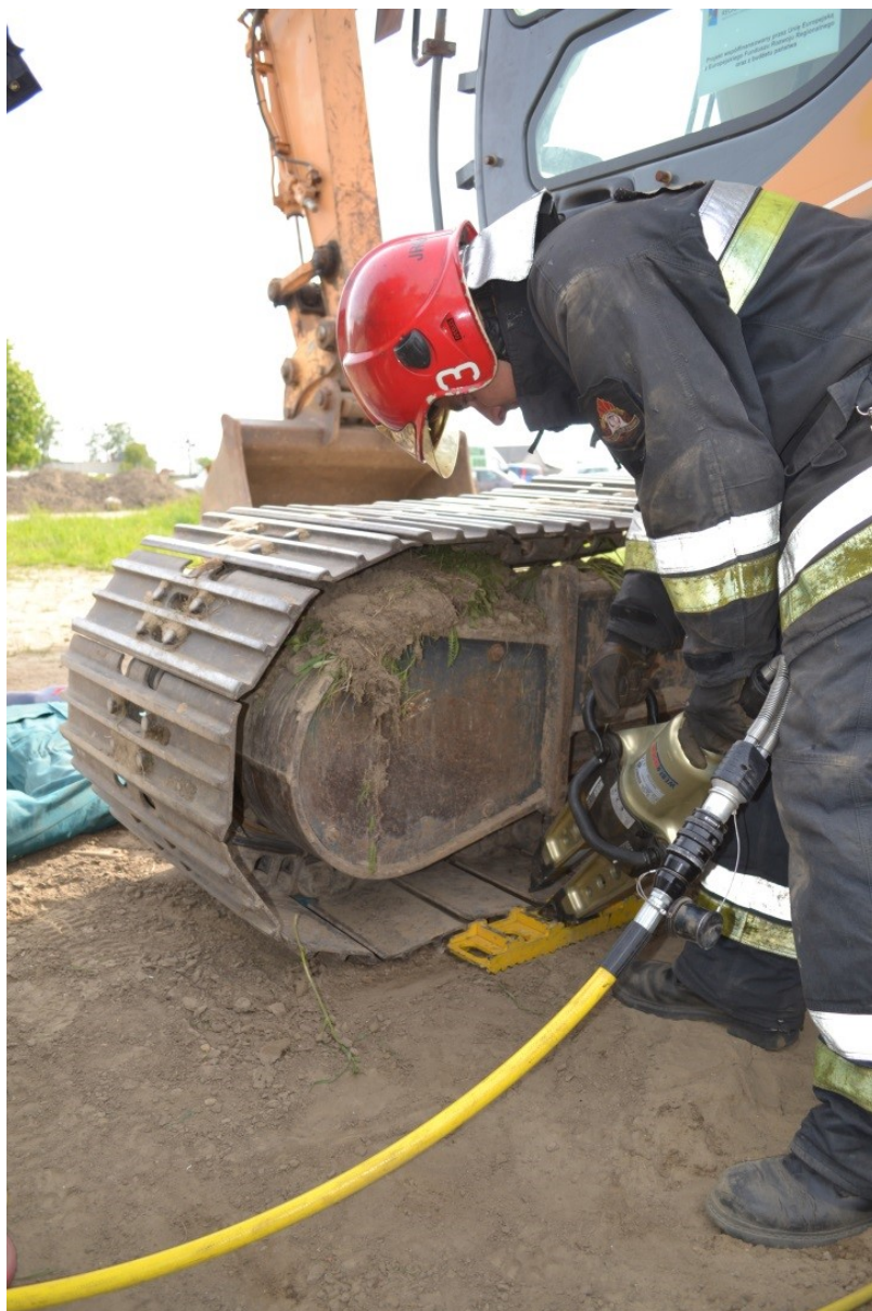
Rys. 387. Rozpieranie samej gąsienicy
