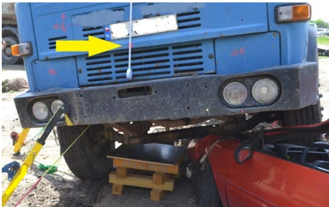
Rys. 368. Powieszenie taśmy mierniczej z zaznaczeniem punktu pozwala zaobserwować niekorzystne przechyły
