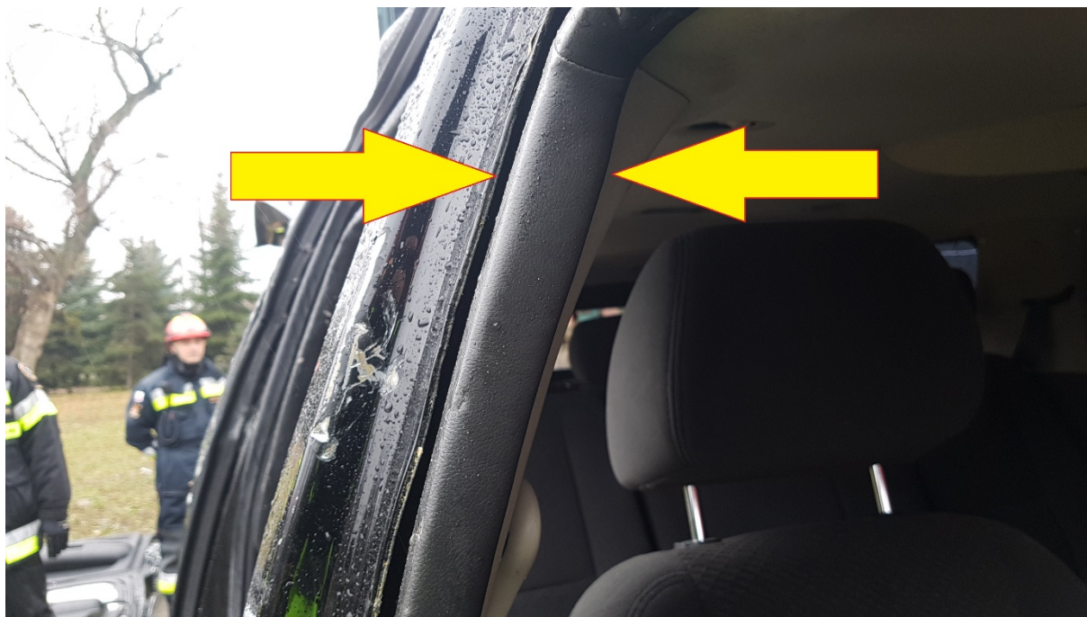
Rys. 449. Wewnętrzny szkielet balistyczny. Okolice słupka C
