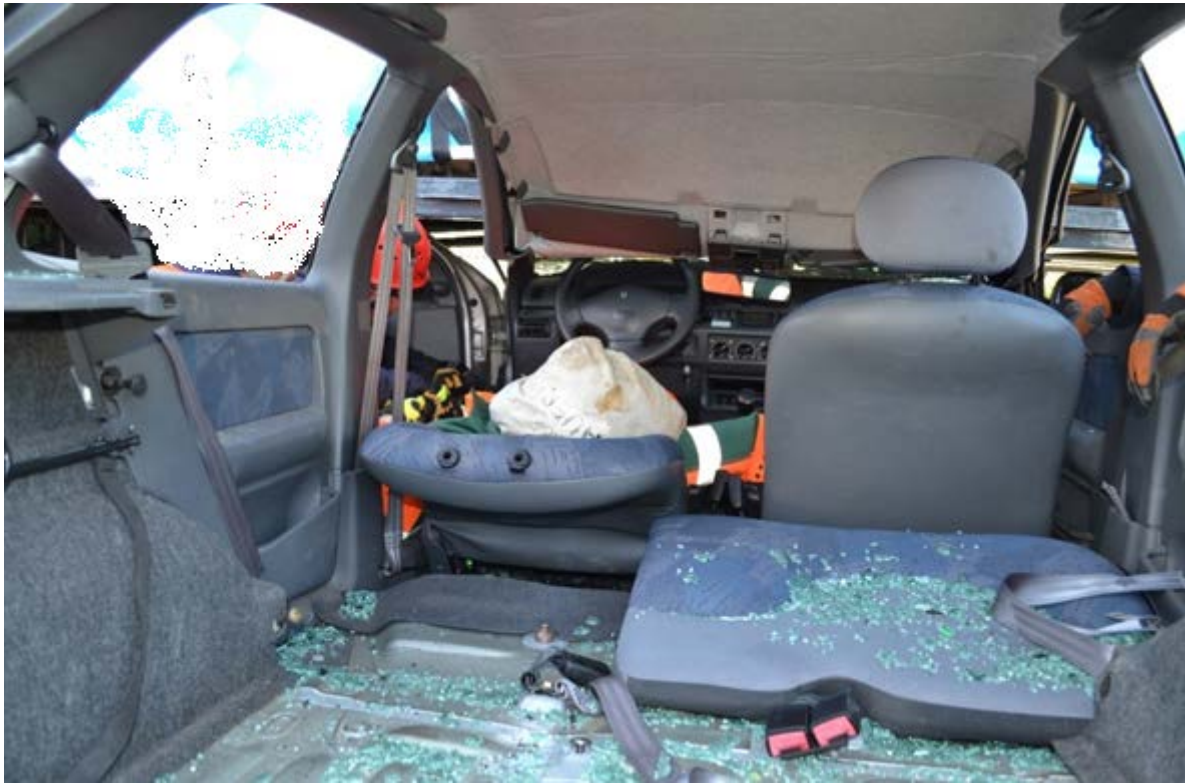
Rys. 356. Szeroki dostęp do osoby poszkodowanej, po wykonaniu techniki „tunelowania”
