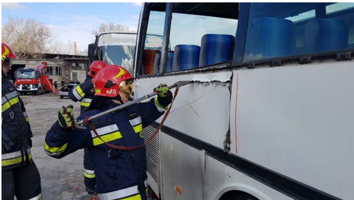
Rys. 403. Cięcie poszycia narzędziem halligan z końcówką tnącą
