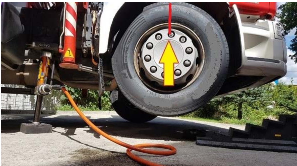
Rys. 377. Podnoszenie ciężarówki cylindrem rozpierającym pod ramą pojazdu. Nie założono tu pasa z nacięciem na koło, które dało by dodatkowe kilkanaście centymetrów przestrzeni pod kołem (ograniczenie obiektu, na którym ćwiczą)
