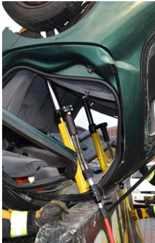
Rys. 315. Stabilizacja i jednoczesne wyparcie dwóch cylindrów rozpierających wewnątrz pojazdu, posadowionych na miejscu styku dachu z barierą umożliwiło ręczne otwarcie drzwi
