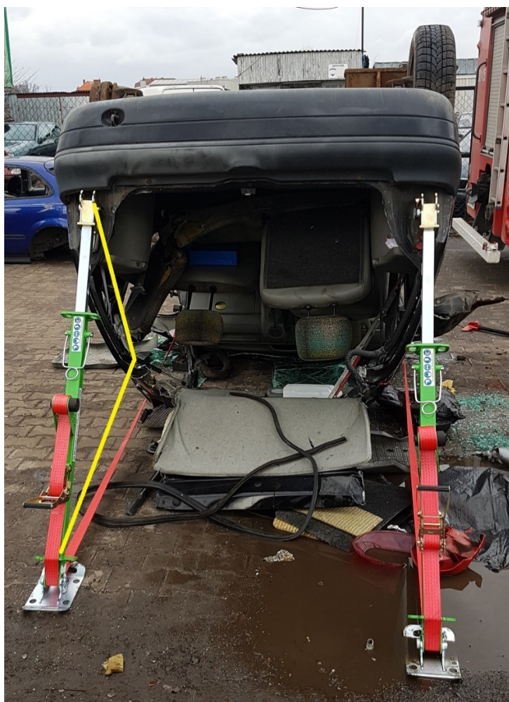
Rys. 303 A, B. Umieszczenie podpory równoległe do podłużnic dachu. Żółtą linią zaznaczono przypadek, w którym podpora nie ma możliwości zdemontowania pasa. Cięcie wzdłużne dachu powiększające przestrzeń
