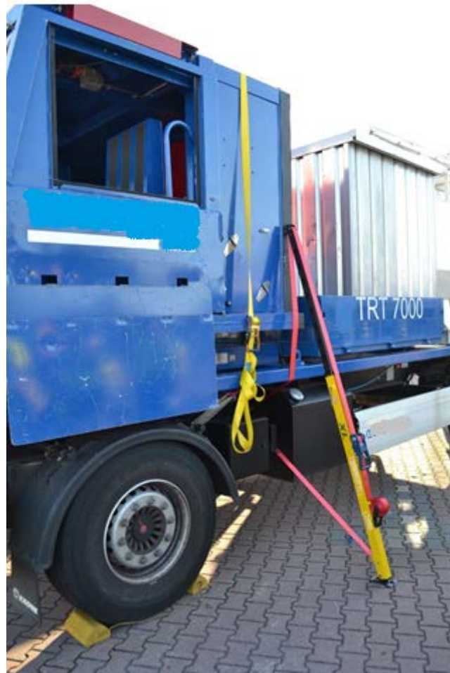
Rys. 332. Stabilizacja pojazdu pasem z naciągiem, biegnącego w poprzek kabiny oraz alternatywna stabilizacja mechanicznymi podporami szybkiej stabilizacji. Widoczne zabezpieczenie przed toceniem pojazdu
