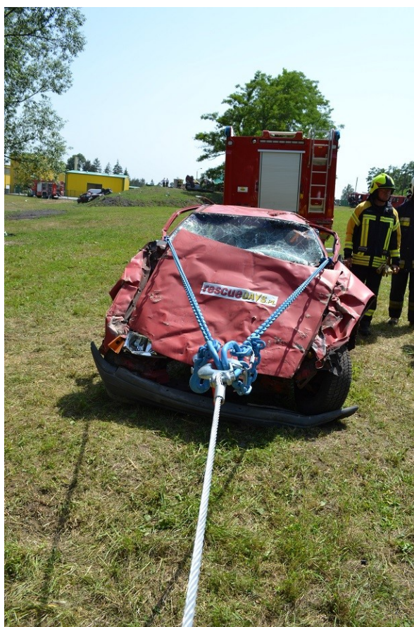
Rys. 441. Wstępne naciągnięcie łańcuchów. Łańcuch lewy i prawy są równej długości, a kąt między nimi zawarty jest ostry
