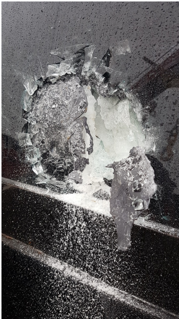
Rys. 461. Efekt kilkunastu uderzeń młotem 5 kg
