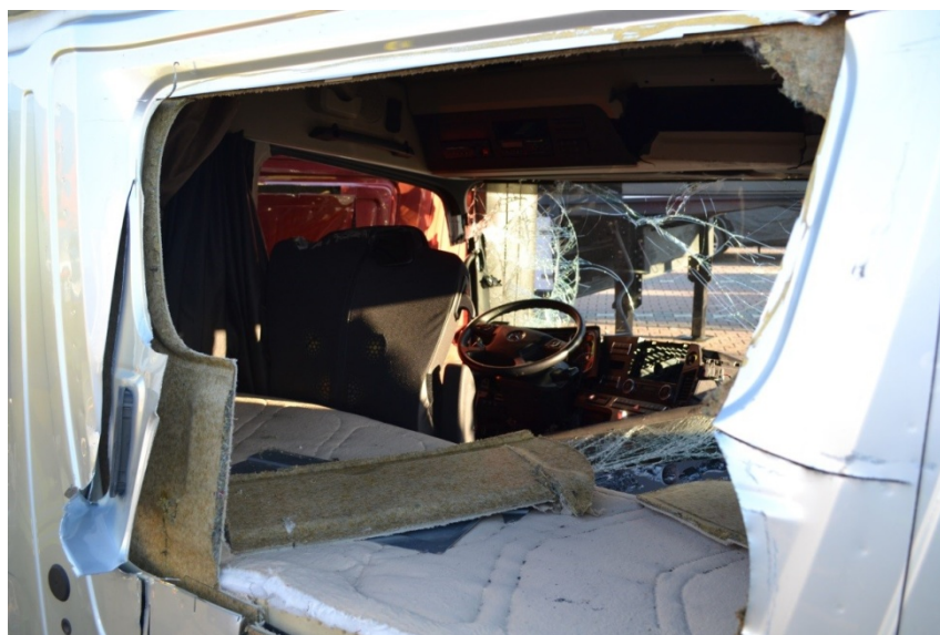
Rys. 351. Szeroki dostęp do osoby poszkodowanej poprzez otwór w tylnej ścianie kabiny
