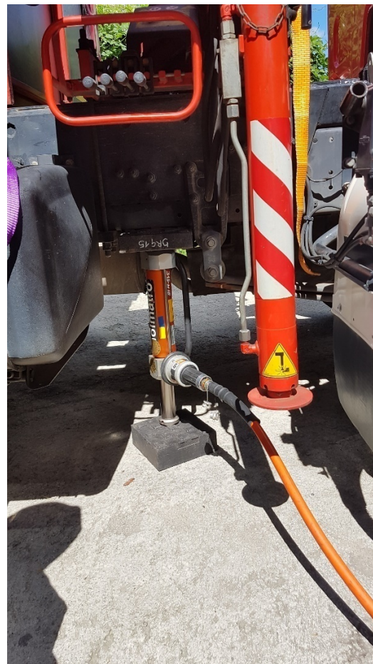
Rys. 376 A, B. Podnoszenie ciężarówki lewarami hydraulicznymi i cylindrem rozpierającym pod ramą pojazdu
