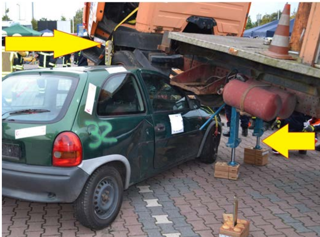
Rys. 373. Podnoszenie ciężarówki przy pomocy podnośników hydraulicznych (po wykonaniu podbudowy i założeniu trzech pasów z naciąganiem)
