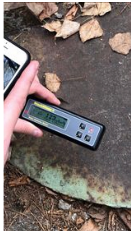
Rys. 17. Pomiar mocy dawki promieniowania wykonany przy pokrywie studni kanalizacyjnej (źródło: materiał własny).
