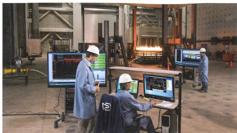
Fot. 2. Podczas wypalania kalibracyjnego naukowcy z National Institute of Standards and Technology mierzą szybkość wydzielania ciepła (pierwszy plan) i monitorują obrazy termiczne o wysokiej rozdzielczości (tło).
