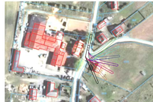
Rys. 34. Analiza minimalnej trajektorii najazdu dla drogi o dopuszczalnej prędkości do 50km/h pojazdu ciężarowego do 30 ton, prawdopodobieństwo uzyskania przejeźdnosci dotyczy prędkości 5km/h, która łączy w sobie hamowanie przed zakrętem i przyspieszenie po jego pokonaniu, efektem może być dodatkowy zakres uciążliwości nieujętych ww. analizowanych modelach dot. hałasu i powietrza
