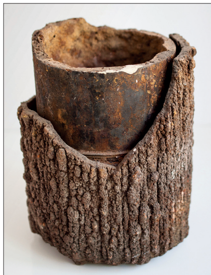
Fig. 5.2. Przykłady wytrącania się osadów z wód leczniczych
