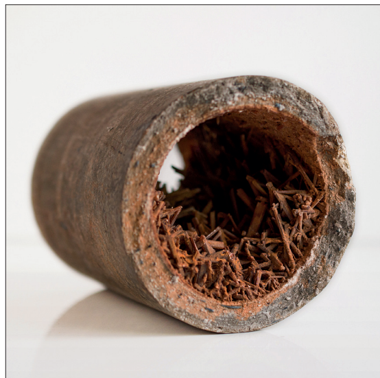
Fig. 5.2. Przykłady wytrącania się osadów z wód leczniczych
