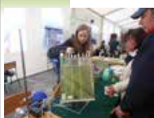
Fotobioreaktor do badań dotyczących możliwości wykorzystania mikroalg, odpadowego dwutlenku węgla oraz ścieków do produkcji biopaliwa, Uniwersytet Gdański
