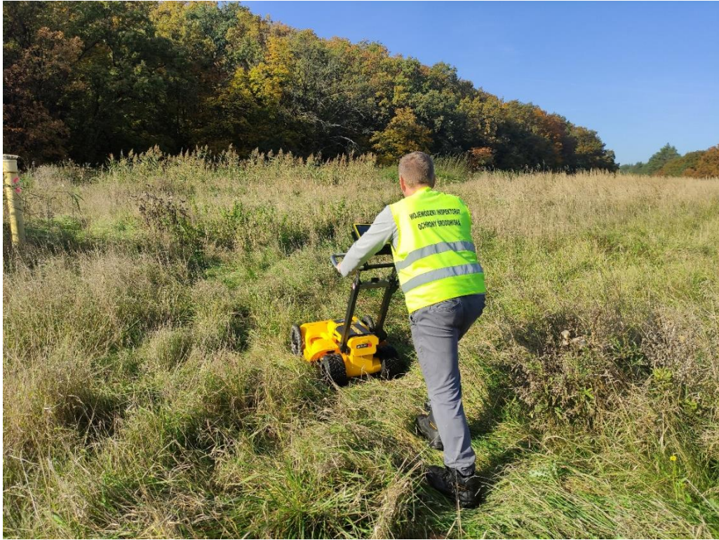
Zdjęcie 7. Wykorzystanie georadaru do czynności inspekcyjnych
