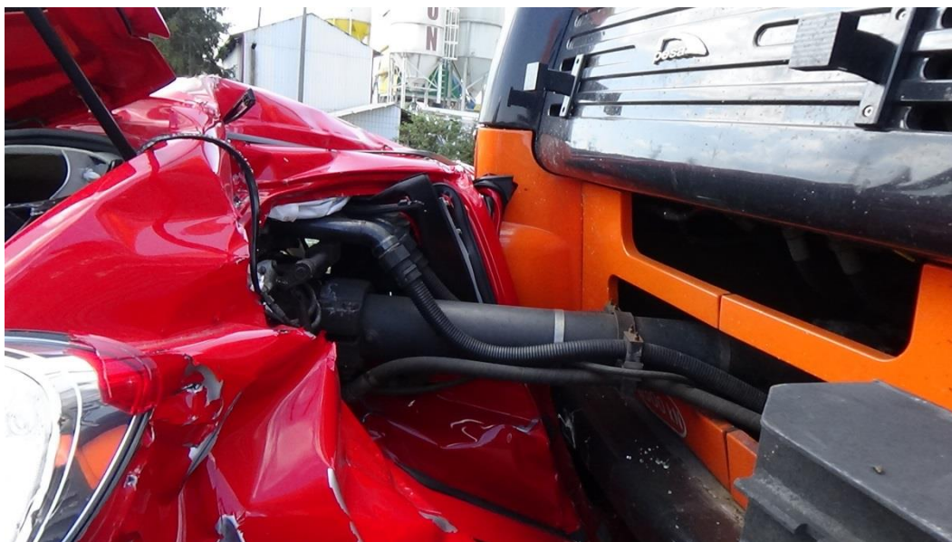
Fot. 1. Skutki uderzenia szynobusu w samochód osobowy Suzuki Baleno
