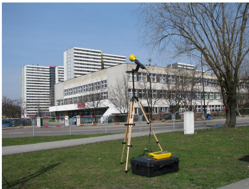
Fot. 4. Analizator widma pól elektromagnetycznych NARDA SRM 3006
