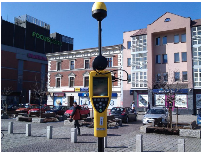
Fot. 3. Miernik szerokopasmowy NARDA NBM-550
