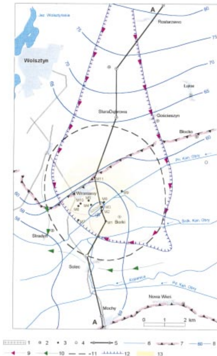
Rys. 8.7-1. Szkic hydrogeologiczny rejonu ujęcia wody Wroniawy.
