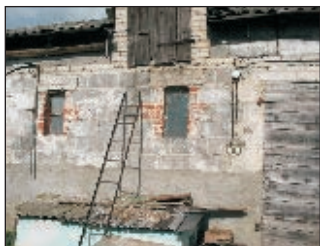
nieprawidłowo skonstruowane drabiny (brak zabezpieczeń przed przechyłem i osunięciem, zły rozstaw szczebli) lub ich zły stan techniczny
