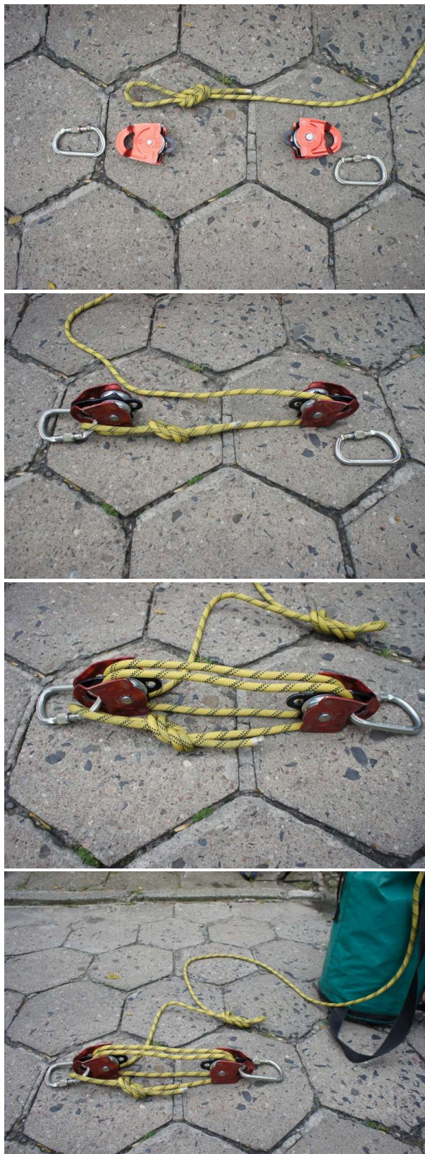
Rys. 54). Układ z przełożeniem 1 : 4
