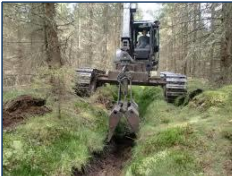
Rycina 48 Nowoczesny sprzęt „Varanen” do prowadzenia czynności utrzymaniowych sieci rowów melioracyjnych w Szwecji (fot. Anja Lomander)
