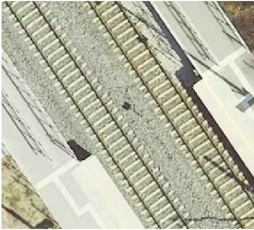
Rys. 9-8 Torowisko kolejowe na podbudowie podsypkowej (B)
