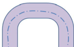
Rys. 5-12 Reprezentacja geometrii linii środkowej w odniesieniu do obiektu świata rzeczywistego 23,45
