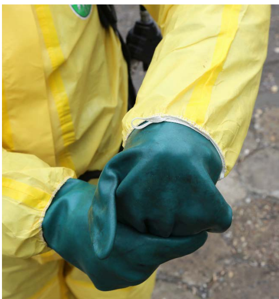
Fot. 14 - 15. Połączenie rękawic z mankietem ubrania ochronnego przy użyciu taśmy o odporności chemicznej. Źródło własne
