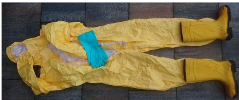
Fot. 1. Ubranie ochrony chemicznej wraz z rękawicami i butami. Źródło własne
