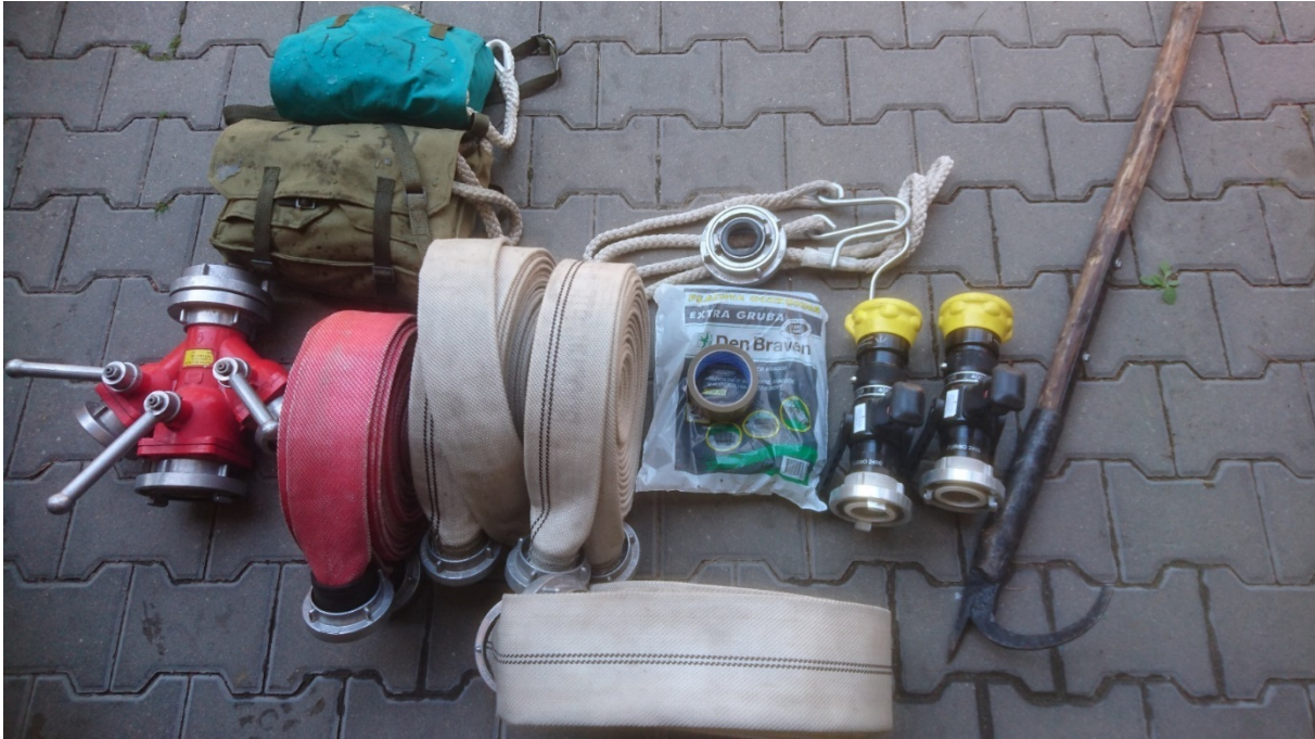
Fot. 50. Sprzęt do sprawienia stanowiska dekontaminacji wstępnej. Źródło: materiały własne
