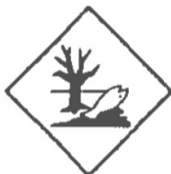
Rys. 23. Materiały zagrażające środowisku – informujące o zagrożeniu w przypadku przedostania się do środowiska wodnego lub kanalizacji
