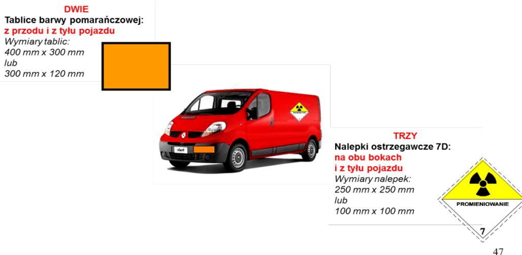
Rys. 20. Oznakowanie samochodu transportującego materiały promieniotwórcze. Źródło własne
