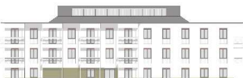
elewacja zachodnia / wschodnia w układzie symetrycznej osiowej, możliwe jako elewacja północna, skala 1:200
