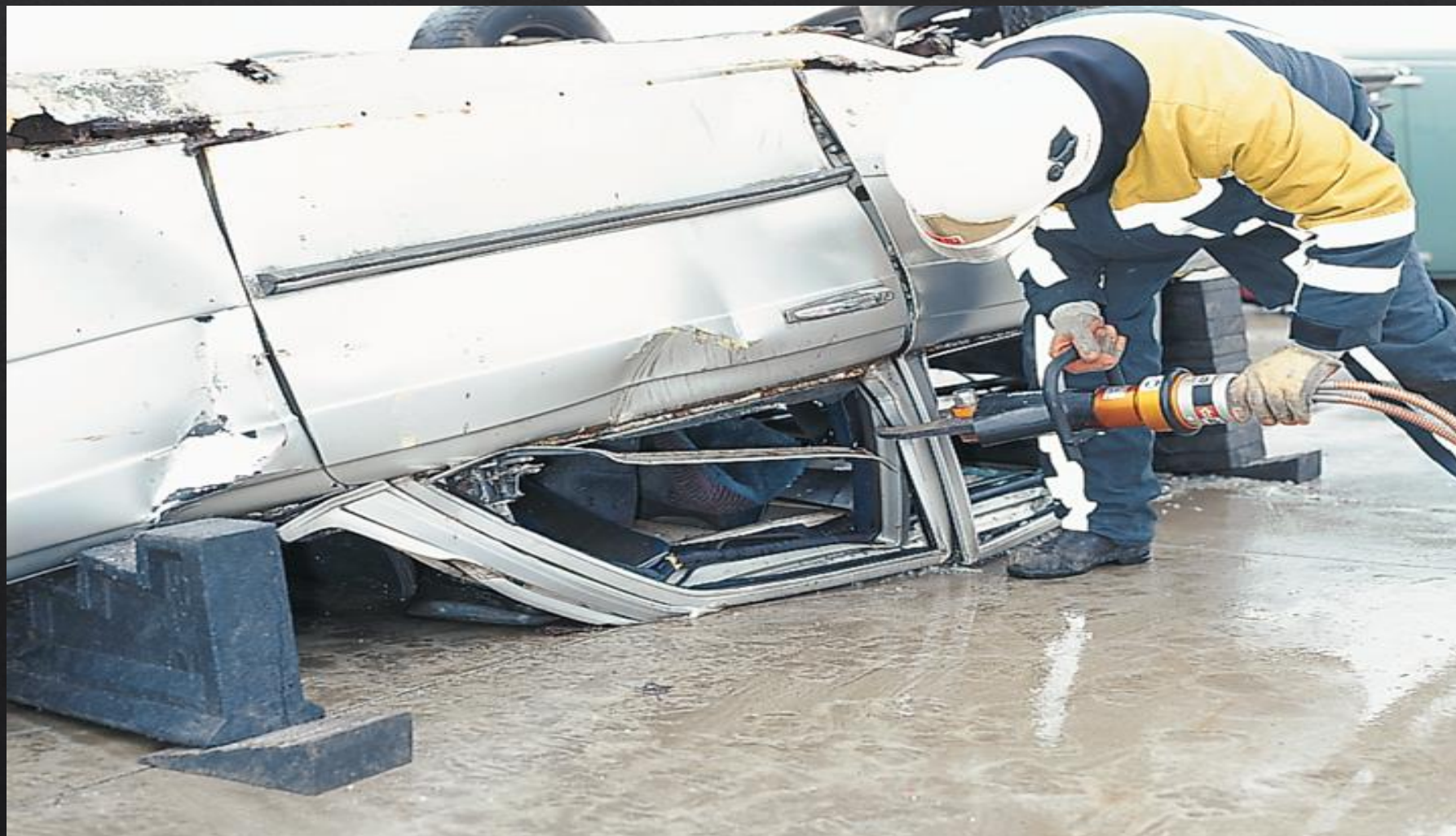
Zdjęcie 2 Stabilizacja pojazdu na dachu
