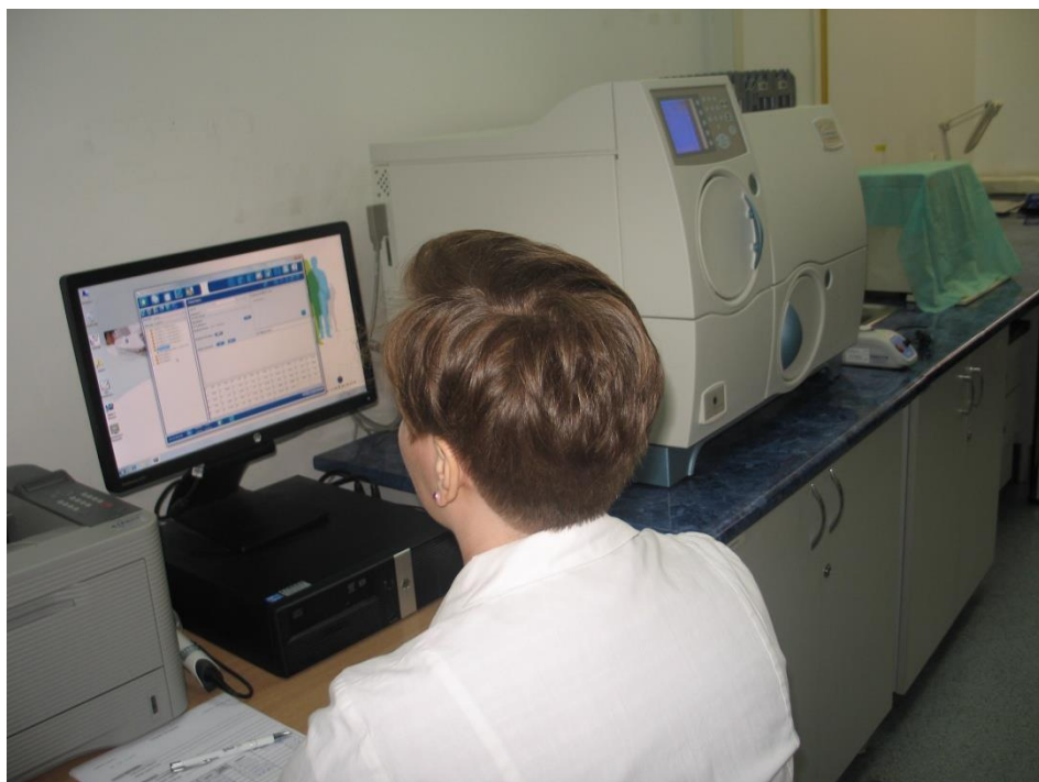
Wykrywanie pałeczek Salmonella spp. na analizatorze VITEK (Fot. Nr 1 WSSE w Białymstoku)
