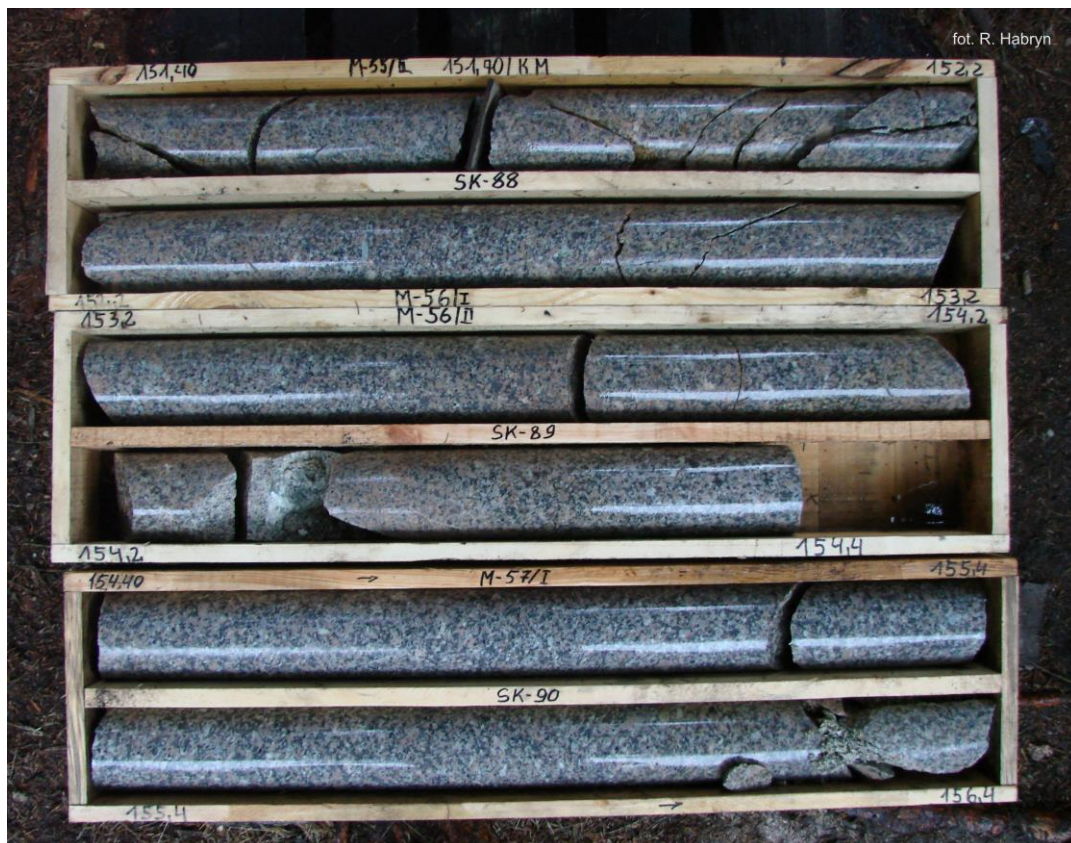
Fig. 3_2 Przykładowy odcinek rdzenia pobranego z otworu Czerwony Potok PIG-1 (głębokość 151,4 - 156,4 m; skała - granitoid średnio-grubokrystaliczny).
