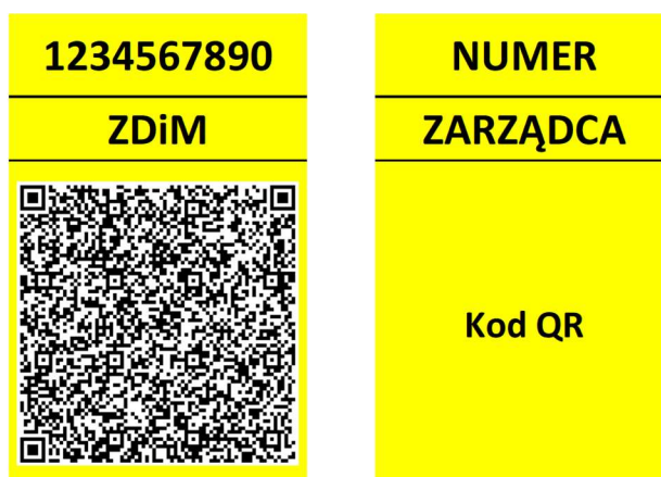
Rys. 7.8.2. Zalecany wzór numeracji latarni drogowej
