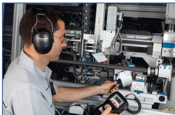
fot. 1 Festo: detekcja akustyczna nieszczelności układu sprężonego powietrza
