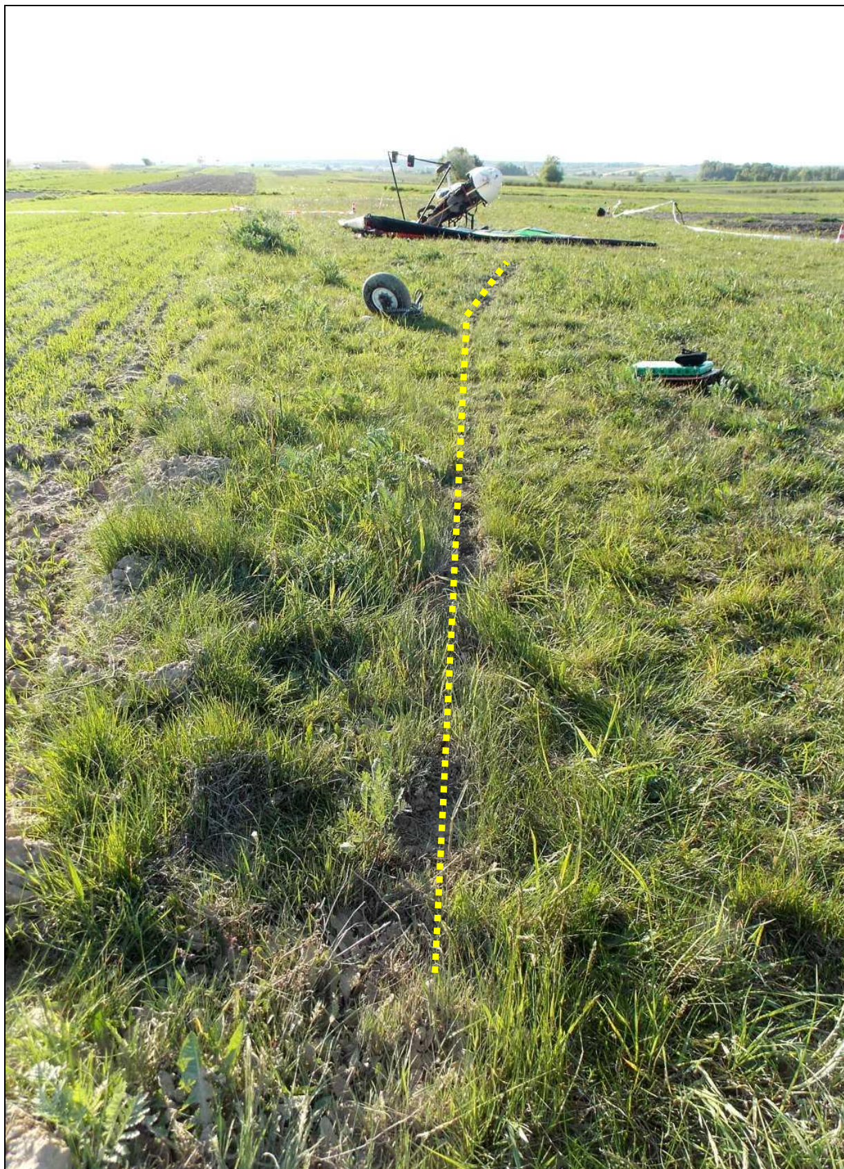
8 – Przewrócona lotnia na miejscu wypadku i zaznaczony ślad jej przemieszczania po uderzeniu w miedzę. Na pierwszym planie widoczne odłamane koło przedniego podwozia z widelcem.
