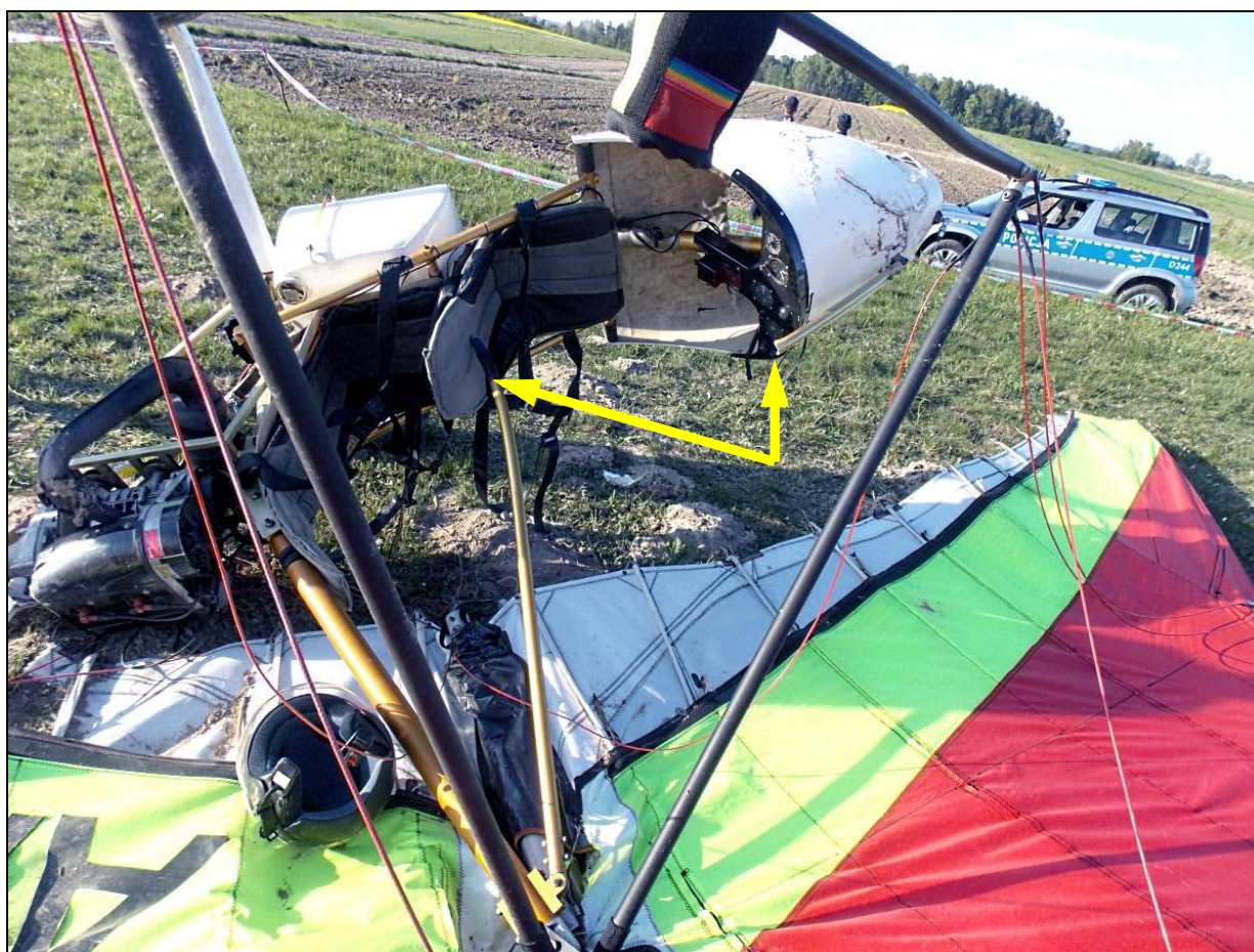
29 – Widok na wózek motolotni. Strzałkami zaznaczone złamanie przedniego pręta wózka. Trójkąt sterowniczy w kolorze czarnym.
