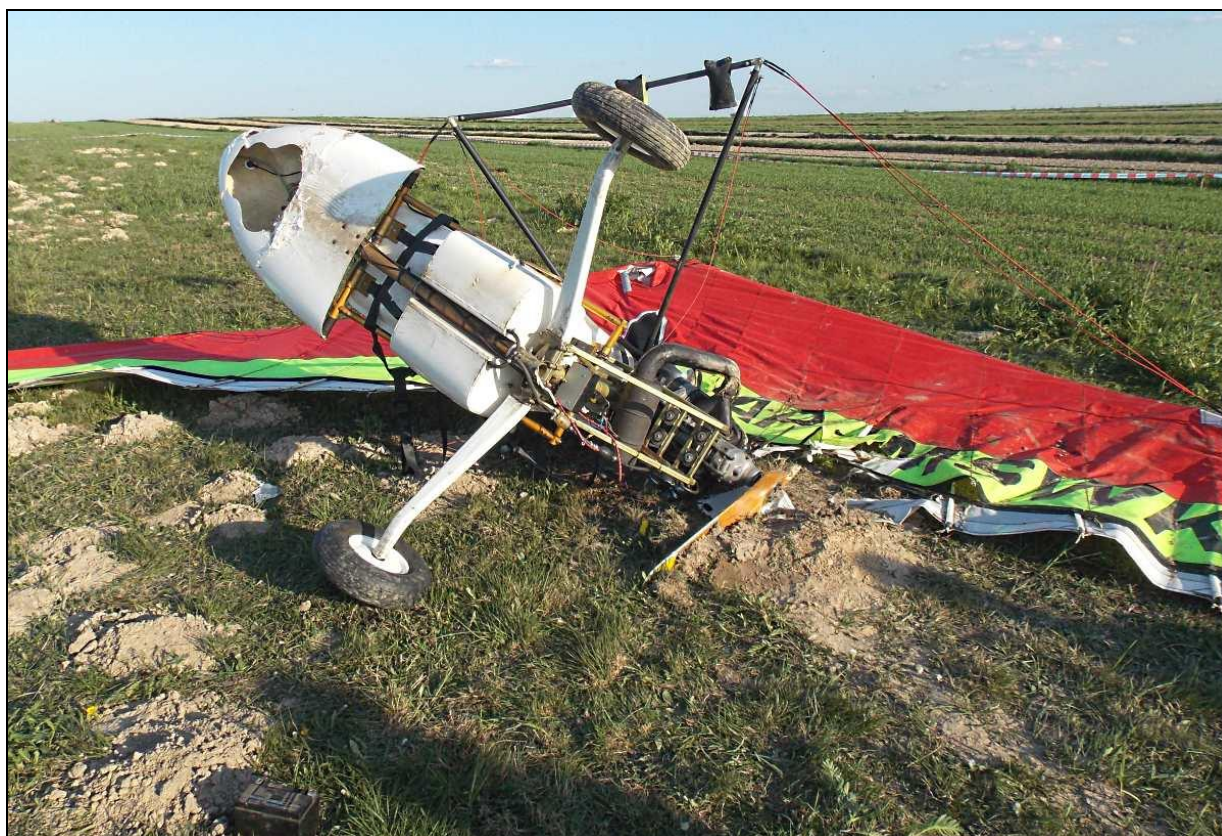
21 – Ogólny widok rozbitej motolotni. Widoczne zniszczone śmigło i uszkodzony spływ lewej części skrzydła.
