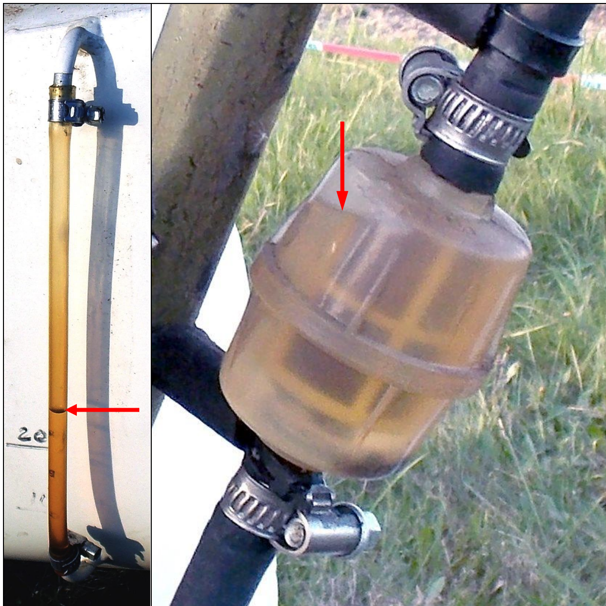
39, 40 – Wskaźnik poziomu paliwa i filtr paliwa. W filtrze obecne paliwo. Poziom paliwa pokazany strzałkami.
