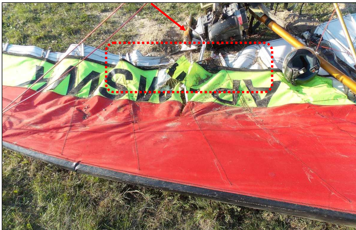
19 – Lewa wewnętrzna część skrzydła od dołu i od przodu. Widoczne uszkodzenia spływowej części skrzydła spowodowane kontaktem z pracującym śmigłem i zniszczone śmigło.
