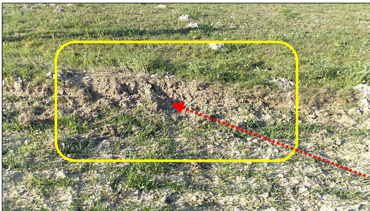
7 – Miejsce uderzenia przedniego podwozia w wysoką miedzę. Zaznaczony ślad koła.
