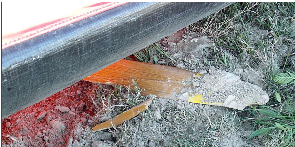
28 – Zbliżenie na odłamane łopate śmigła, leżącą pod lewym skrzydłem.
