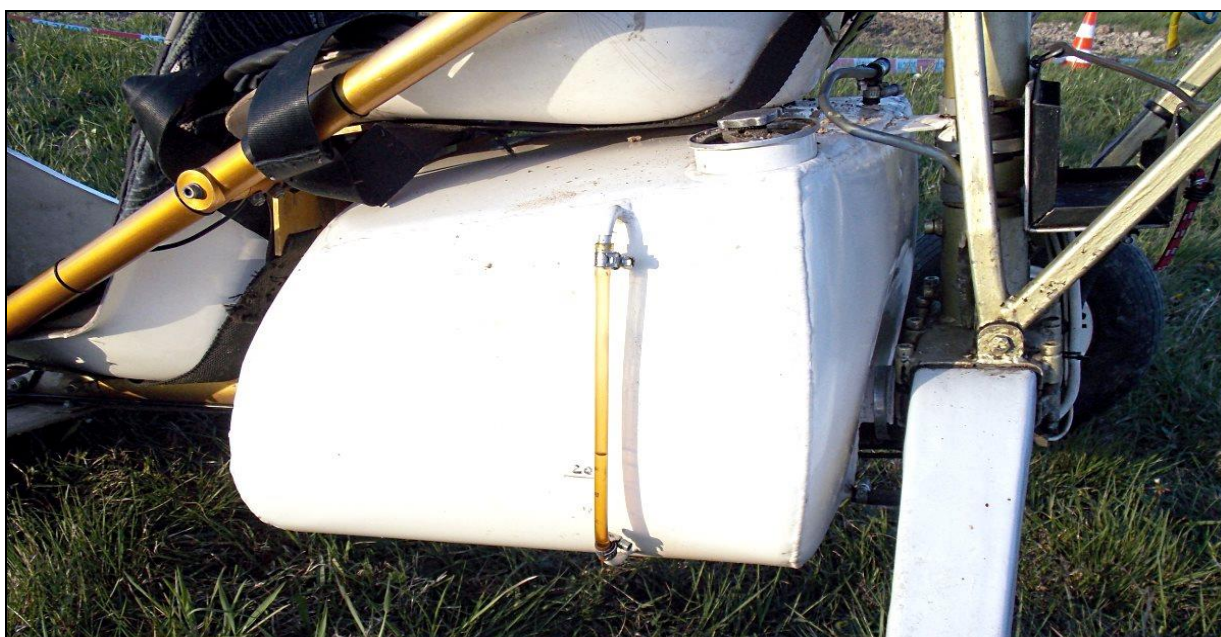
38 – Umieszczony pod tylnym fotelem zbiornik paliwa ze wskaźnikiem poziomu paliwa.
