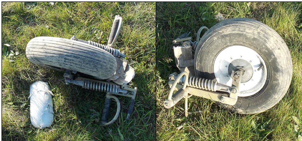
9, 10 – Odłamane koło przedniego podwozia z elementami widelca.
