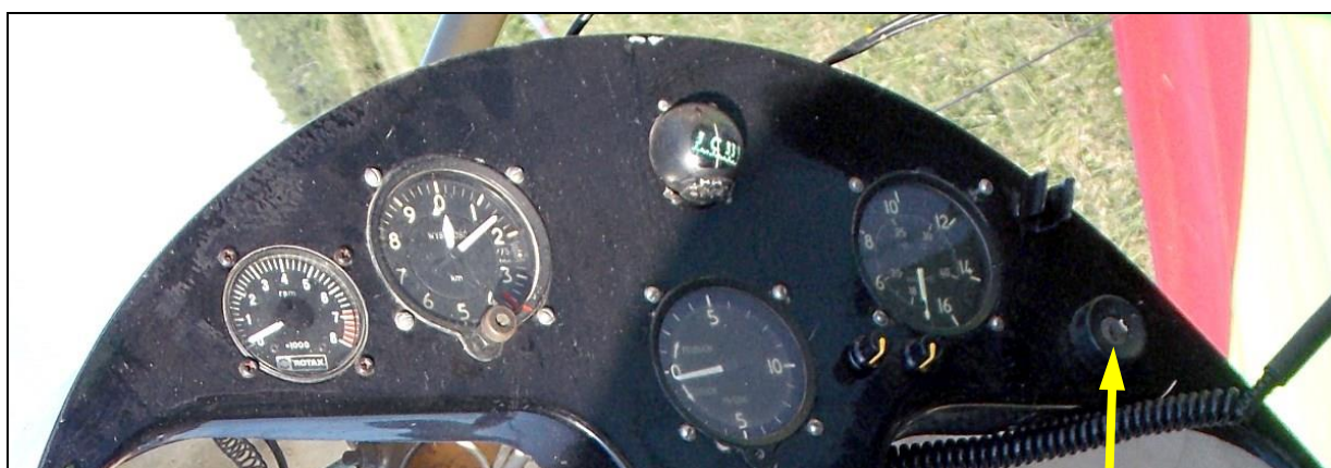
33 – Tablica przyrządów. W stacyjce zapłonowej ułamana końcówka kluczyka.
