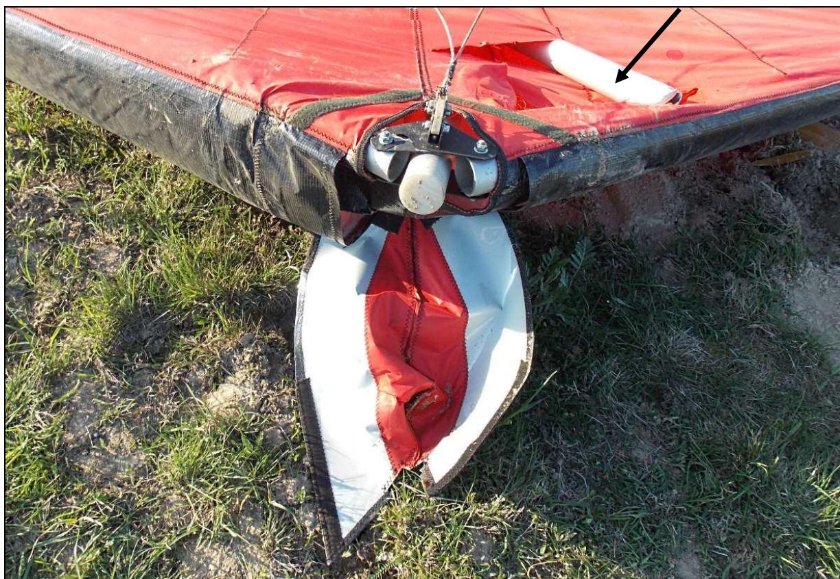
17 – „Dziób” skrzydła po zderzeniu z ziemią, zdjęte pokrycie. Widoczny złamany kil wystający z pokrycia.
