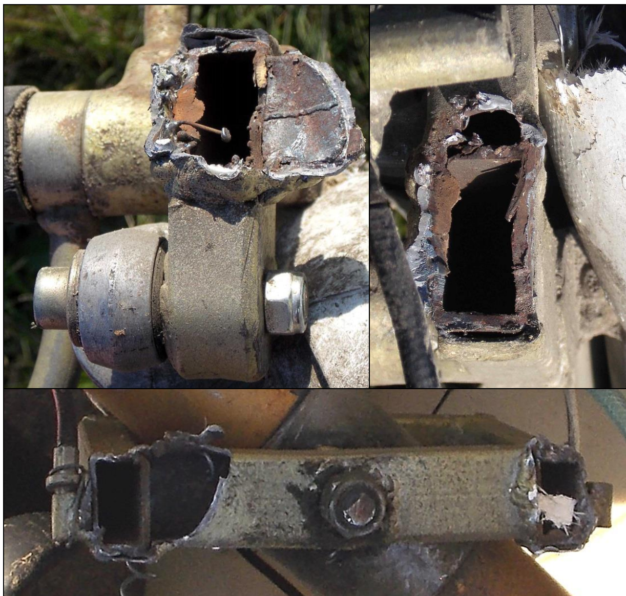
11, 12, 13 – Przełomy widelca przedniego podwozia. Widoczna zaawansowana korozja penetrująca w spoiny.
