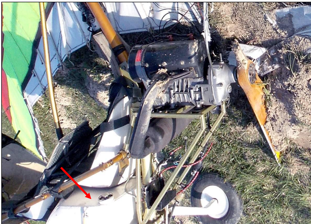
37 – Zespół napędowy motolotni – łożo silnika, silnik, śmigło i zbiornik paliwa (zaznaczony strzałką).
