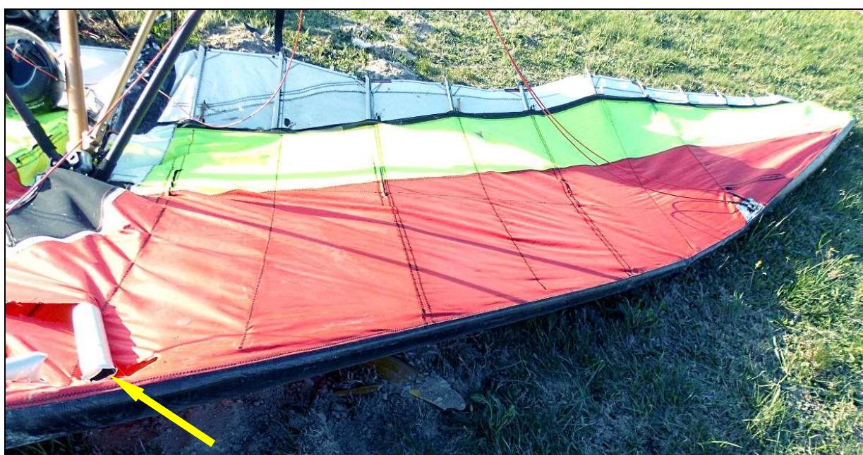
27 – Ogólny widok na lewą część skrzydła od dołu i od przodu. Strzałką wskazany złamany kil.
