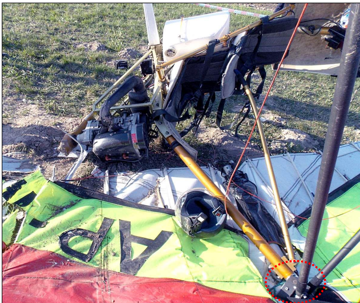
30 – Widok na centralną część skrzydła i maszt wózka z zaznaczonym głównym węzłem mocowania skrzydła.
