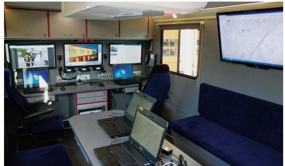
Samochód Dowodzenia i Łączności kompanijne stanowisko kierowania – wygląd wewnętrzny (pulpit operatorski oraz miejsce dla pracy sztabu), fot. Marcin Wróblewski
