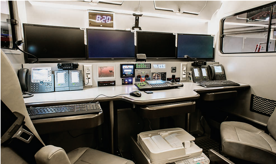
Samochód Dowodzenia i Łączności batalionowe stanowisko kierowania – wygląd wewnętrzny (pulpit operatorski), fot. WISS
