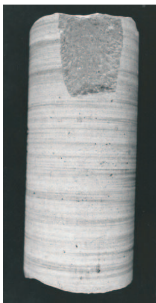
Rys. 3.12. Ślady tarcia koronki na poboczniczy rdzenia sugerujące laminację skały
