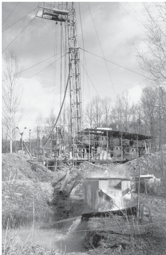
Rys. 4.15. Wypływ szczawy termalnej z odwiertu GT-1 o głębokości 1700 m w Dusznikach Zdroju po zakończeniu prac wiertniczych (luty 2002 r.; fot. Wojciech Ciężkowski).
