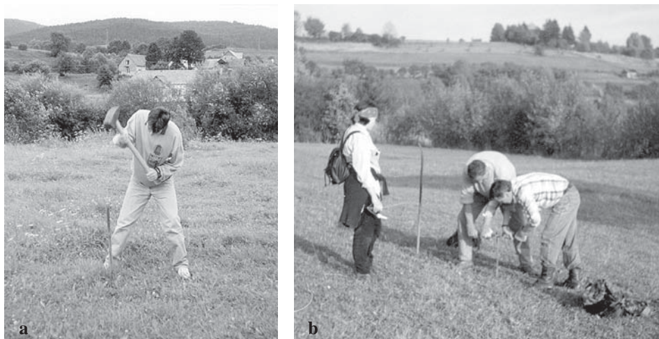
Rys. 8.3. Wykonywanie otworów przy sporządzaniu zdjęcia \text{CO}_2 w powietrzu podglebowym: a) prętem metalowym poprzez wbijanie (1997 r., Krynica Zdrój, fot. Stanisław Żak), b) ręcznym zestawem wiertniczym (1997 r., Szczawnica, fot. Irena Józefko).
