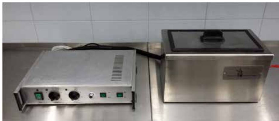
Ryc. 2. Laboratoryjne urządzenie do obróbki ultradźwiękowej mięsa
