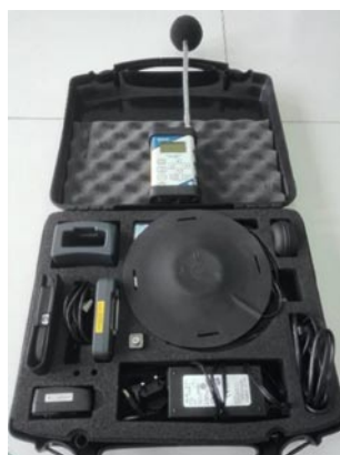
Ilustracja 7. Miernik poziomu dźwięku SVAN 948 oraz zestaw do pomiaru drgań mechanicznych Vib008 – Pracownia fizyczna laboratorium Wojewódzkiej Stacji Sanitarnej-Epidemiologicznej w Kielcach
