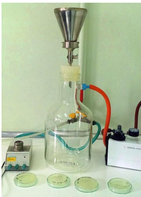
Ilustracja 2. Zestaw do filtracji membranowej - Pracownia mikrobiologii wody laboratorium Wojewódzkiej Stacji Sanitarно-Epidemiologicznej w Kielcach
