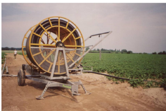
Fot.10.1. Widok deszczowni szpulowej
