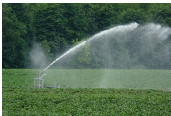
Fot. 10.2. Widok działka wodnego przygotowanej do pracy deszczowni szpulowej w pracy na plantacji ziemniaka
