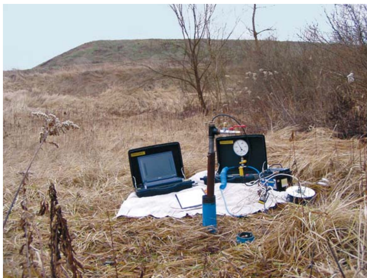
Ryc. 3.11. Piezometr 2 podczas badania metodą PARAMEX, na drugim planie widoczne składowisko odpadów
