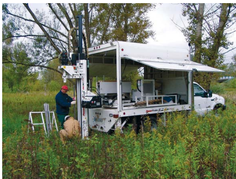
Ryc. 3.4. Profilowanie osadów czwartorzędowych w sąsiedztwie składowiska (sonda PowerProbe)
