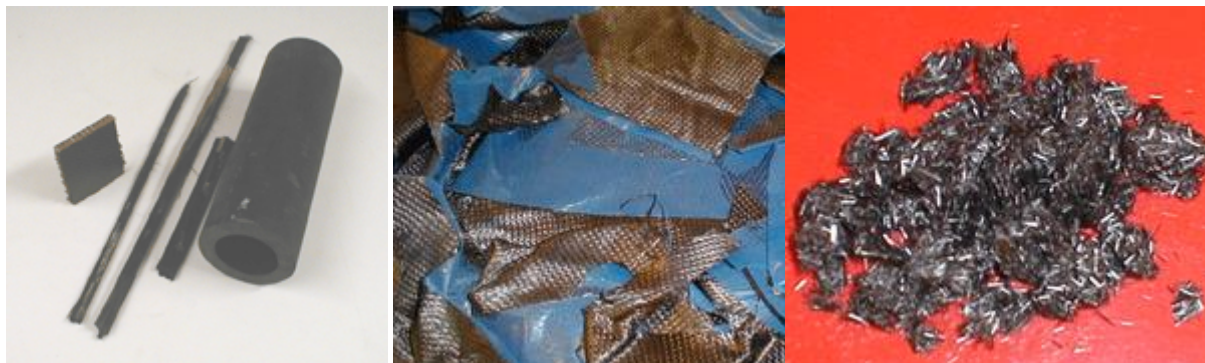
Rysunek 5. Przetwarzanie odpadów z włókna węglowego przed i po procesie pirolizy (metoda ReFiber)
