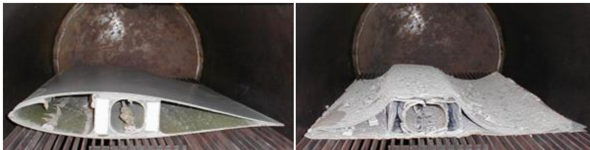
Rysunek 4. Łopata turbiny wiatrowej przed i po procesie pirolizy (metoda ReFiber)
