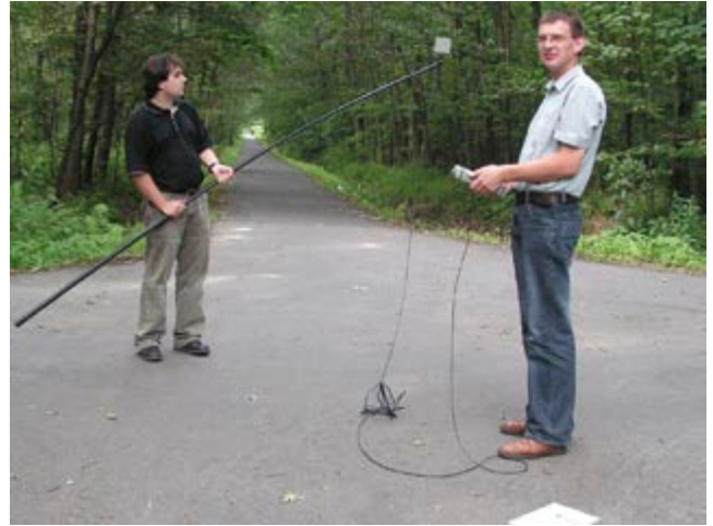
Fot. 2. Pomiary pól elektromagnetycznych w środowisku (S. Konieczny)
