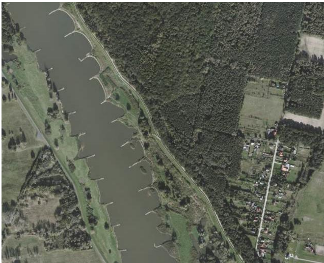
Rysunek 6.4.1. Rzeka Odra uregulowana systemem poprzecznych budowli regulacyjnych zwanych ostrogami
