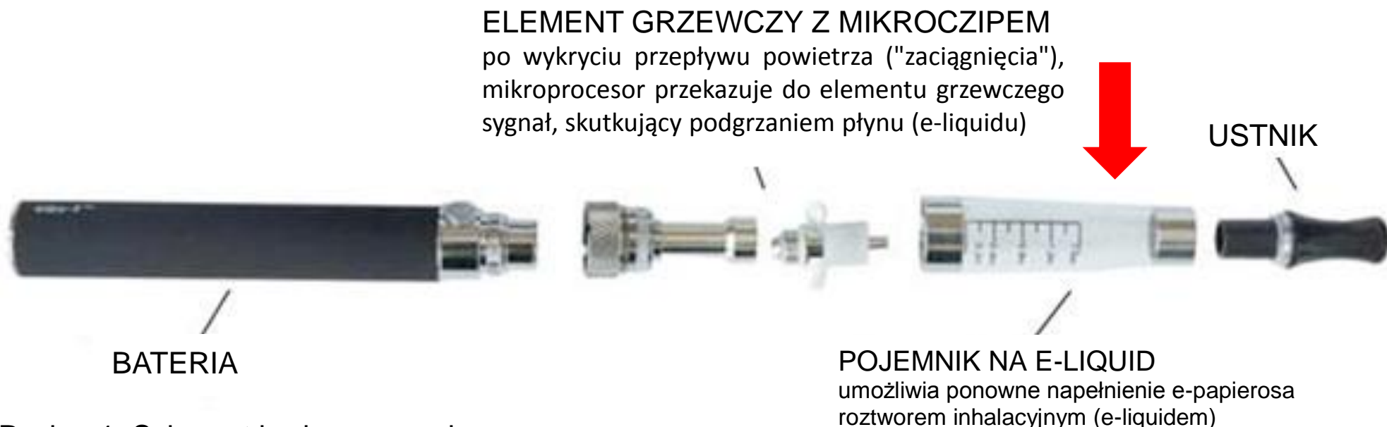
Rycina 1. Schemat budowy e-papierosa
