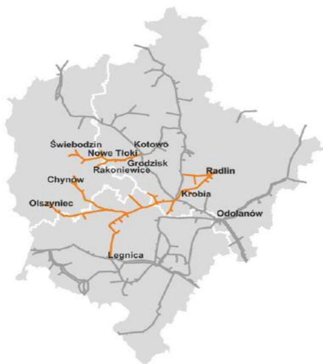
Rysunek 11. System przesyłowy gazu ziemnego zaazotowanego
