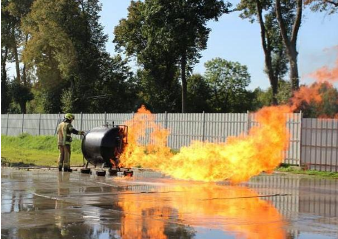
Rys. 11. Emisja fazy ciekłej z zapłonem.
