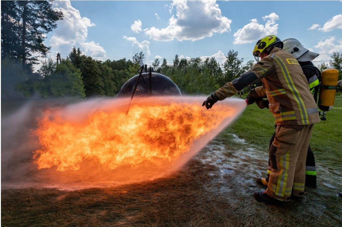
Rys. 13. Emisja fazy ciekłej z elementem ogrzewania płaszczu zbiornika.
