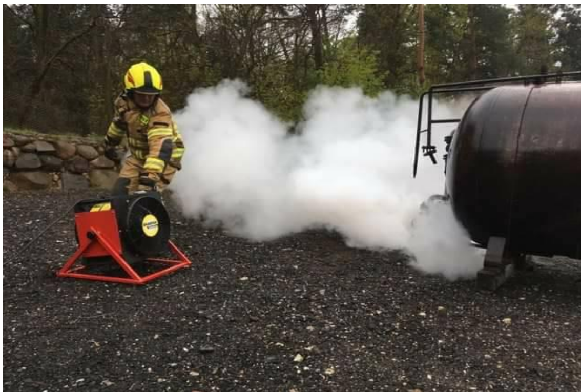
Rys. 10. Wykorzystanie wentylatora w wykonaniu EX do kierunkowania lub ograniczania strefy zagrożonej zapłonem i/lub wybuchem.
