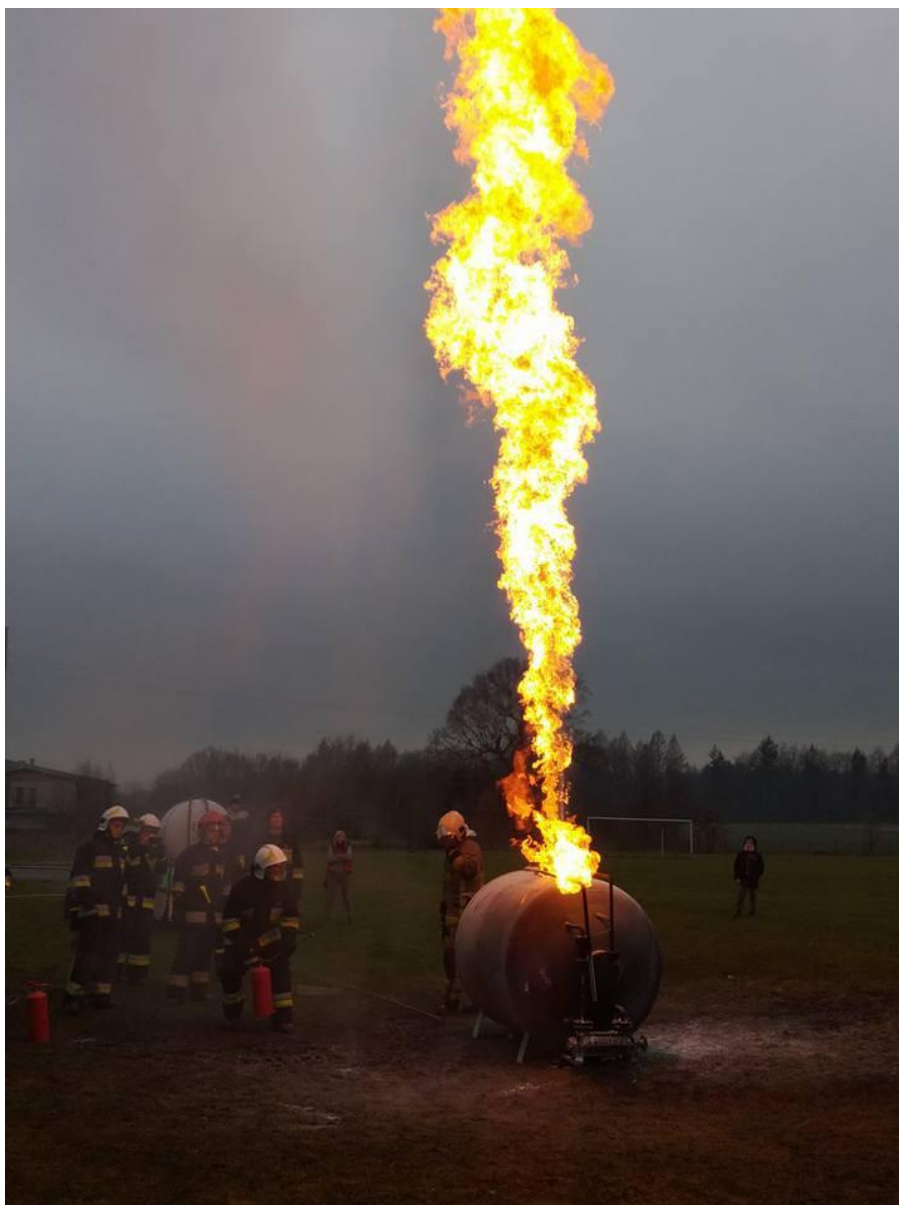
Rys. 12. Emisja fazy gazowej przez zawór bezpieczeństwa jako symulację uszkodzenia z zapłonem
