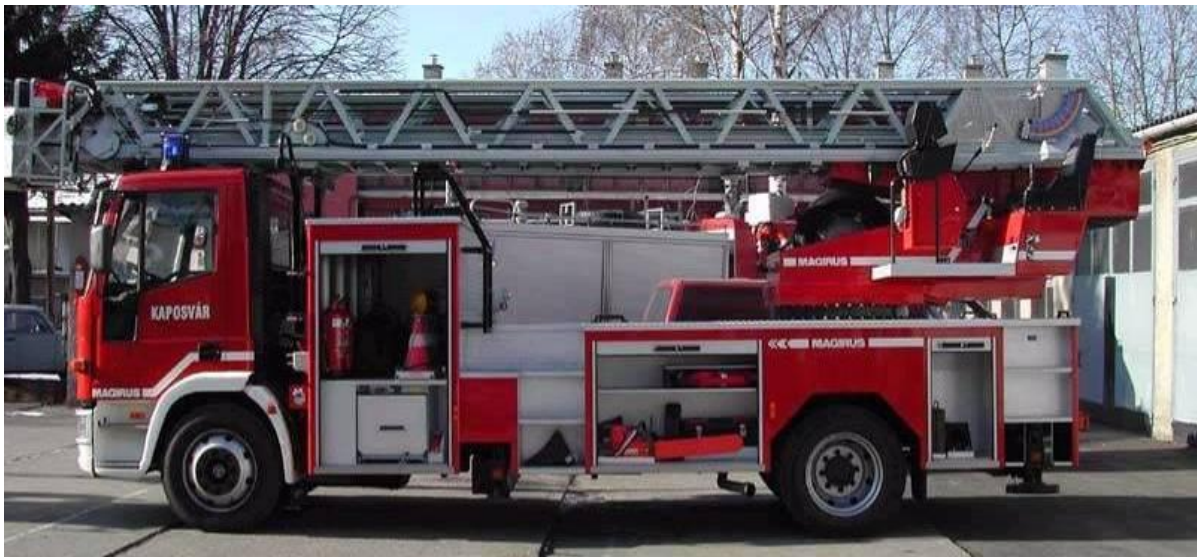
Fot. 5. Samochód specjalny – drabina obrotowa Iveco Magirus DLK 23 na podwoziu Iveco typ FF 150 E 27.
