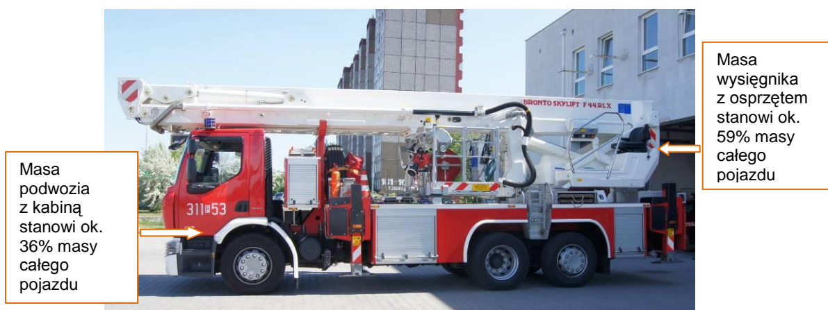
Fot. 1. Samochód specjalny – podnośnik SH 43 z drabiną ratowniczą
