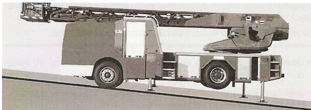
Ryc. 37. Przykład podparcia samochodu specjalnego - drabiny.
