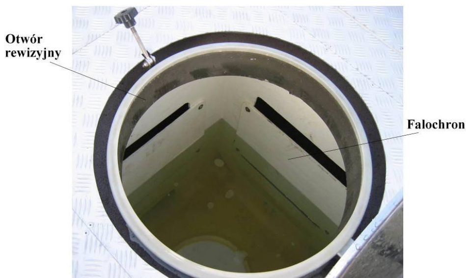
Fot. 6. Zbiornik wody z przykręconymi falochronami.
