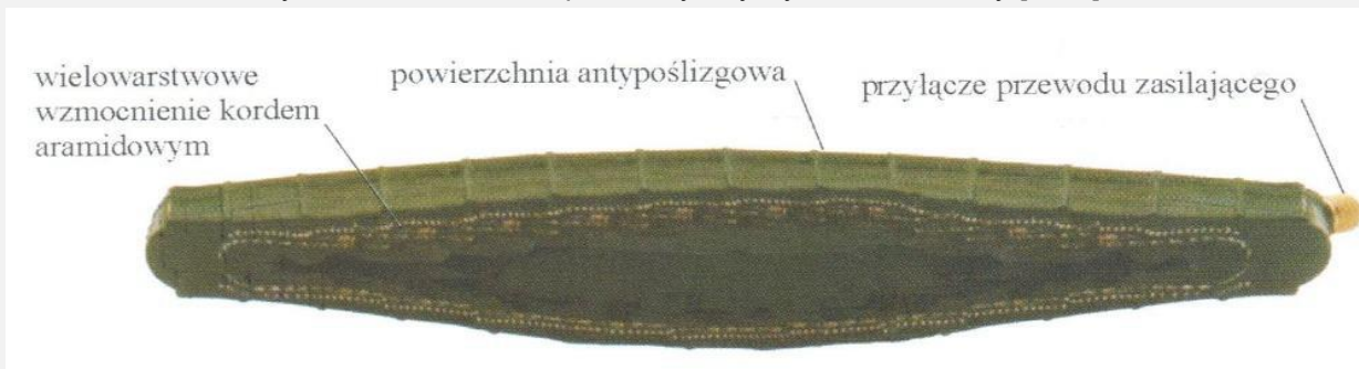
Rysunek nr 6. Budowa siłownika pneumatycznego wysokociśnieniowego [1,2,3].
