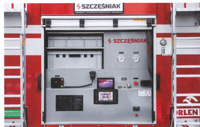
Skrytka tylna, panel obsługi autopompy
