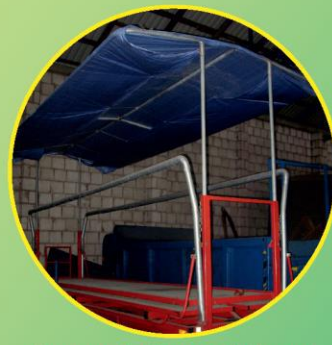
Zamontowanie osłony przeciwsłonecznej i przeciwdeszczowej w platformie do zbierania owoców.
