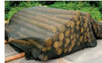
Podstawą prawidłowego magazynowania drewna jest stabilna konstrukcja stosu. Musi być on powalony na równej, stabilnej powierzchni i zabezpieczony z białej strony.
