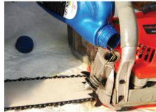
Właściwe smarowanie łańcucha łańcuchowej oraz smarowanie odpowiedniego oleju i paliwa zwiększają bezpieczeństwo pracy piłarką.
