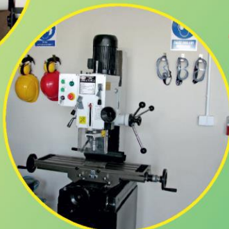
Wyposażenie elektronarzędzi w osłony oraz używanie podczas ich obsługi środków ochrony indywidualnej.
