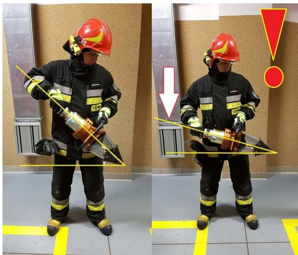
Rys. 35. Trzymanie manetki rozpieracza podchwytym, które utrzymuje prawidłowy kąt pracy narzędzia
