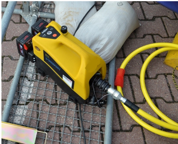
Rys. 21. Agregat zasilający o napędzie elektrycznym. Tu w budowie zastosowano dwa akumulatory
