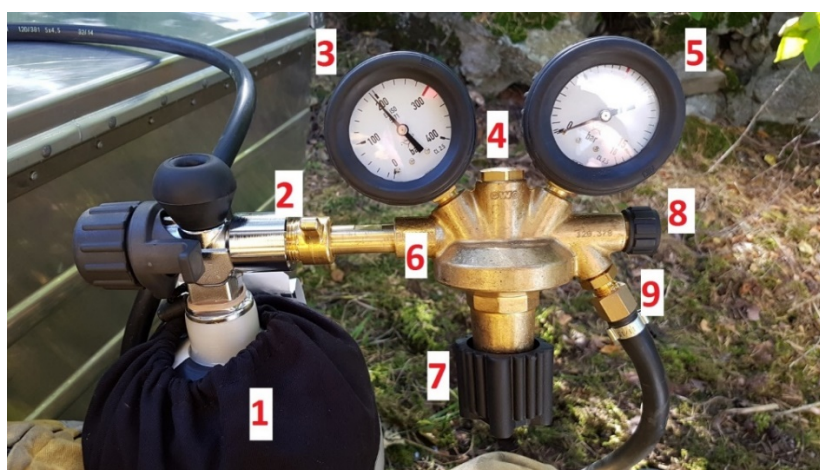
1. Butla ze sprężonym powietrzem. 2. Przyłącze gwintowe. 3. Wskaźnik ciśnienia w butli. 4. Zawór bezpieczeństwa 5. Wskaźnik ciśnienia zredukowanego. 6. Korpus reduktora. 7. Śruba nastawna. 8. Zawór iglicowy. 9. Kolektor wyjściowy z zestawem węża
