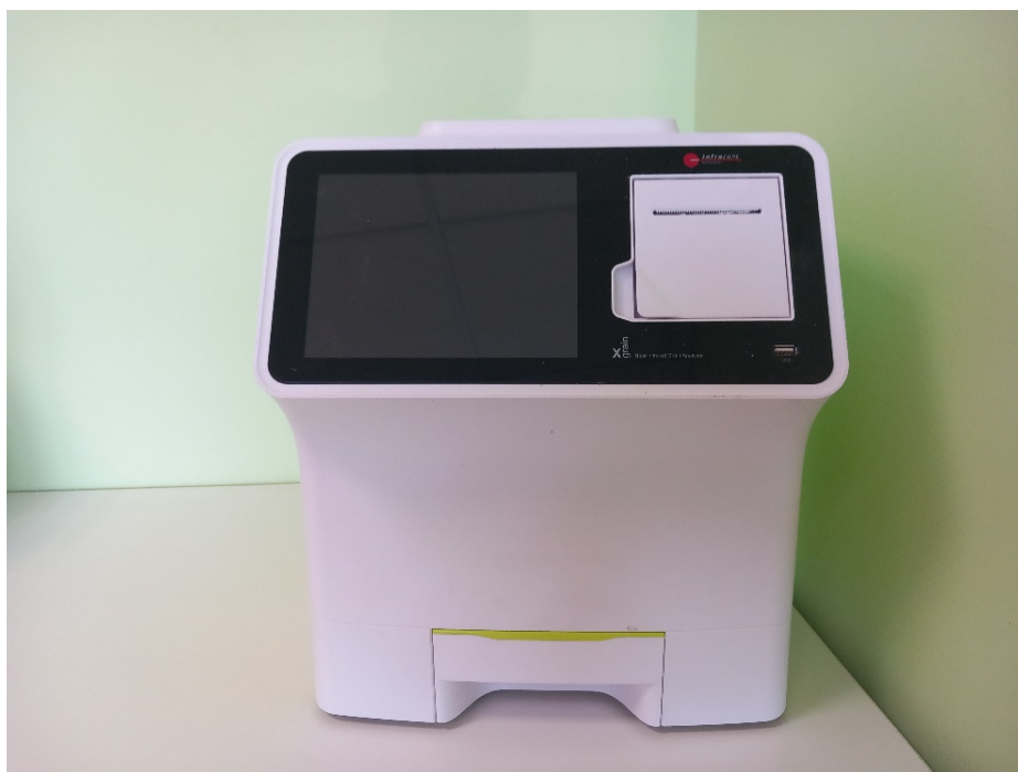
Zdjęcie 1. Analizator ziarna – analizator bliskiej podczerwieni do ziarna i mąki służący do określania składników ziaren zbóż, ziaren oleistych i mąk z wbudowanym modułem wagi hektolitrowej.
