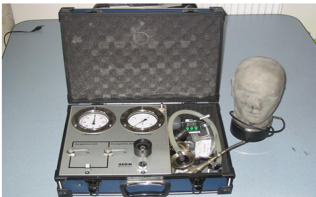
MULTITEST-PLUS – zestaw służący do sprawdzania szczelności masek do aparatów powietrznych;
