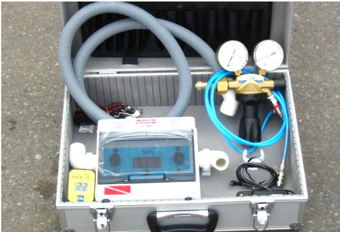
Mieszalnik nitroksowy NX 2003 z analizą – sprzęt służący do sporządzania mieszanek powietrznych o wzbogaconej do 40 %, zawartości tlenu, wykorzystywanej do głębokiego nurkowania.
