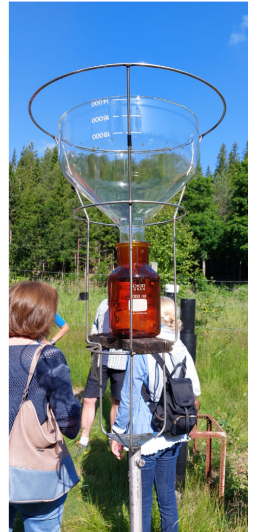
Urządzenia pomiarowe na stacji w Birkenes, od lewej: wewnątrz urządzenia do depozycji rtęci, urządzenie do depozycji jonów, urządzenie do depozycji zanieczyszczeń organicznych (fot. GIOŚ)
