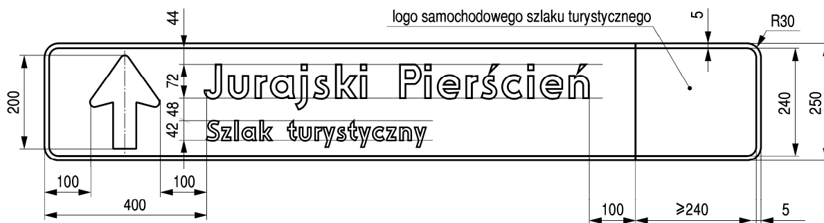
Rys. 9.5.54. Konstrukcja znaku E-22a
