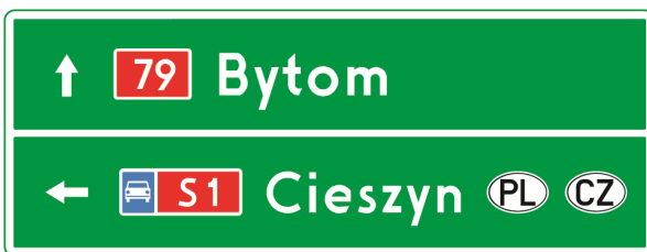
Rys. 6.3.2.4. Drogowskaz E-2a wskazujący dojazd do drogi ekspresowej
