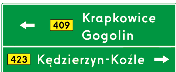
Rys. 6.3.2.2. Drogowskaz E-2a z nazwami dwóch miejscowości kierunkowych na jednym kierunku
