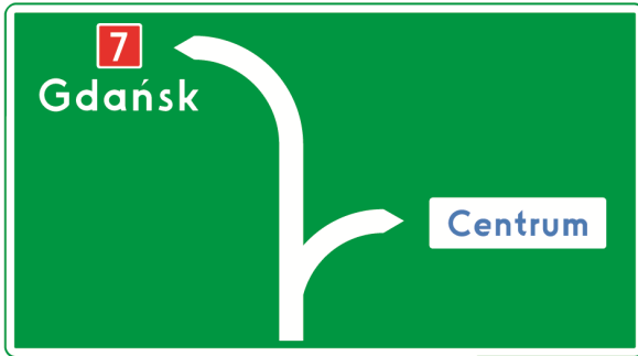
Rys. 6.3.1.6. Tablica E-1 podająca informację lokalną
