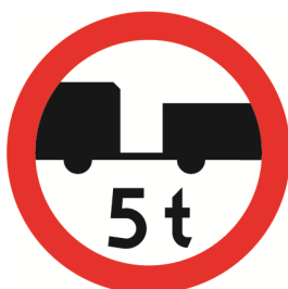
Rys. 3.2.8.2. Znak B-7 podający masę przyczepy
