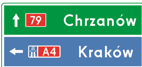
Rys. 6.3.2.6. Drogowskaz E-2e wskazujący dojazd do autostrady
