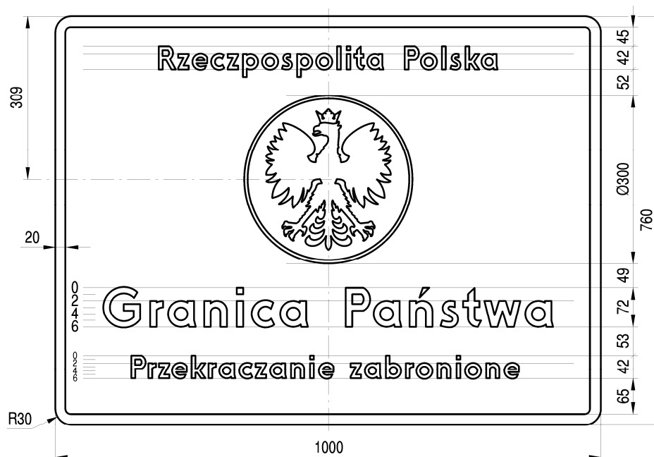
Rys. 9.6.2. Konstrukcja znaku F-2
