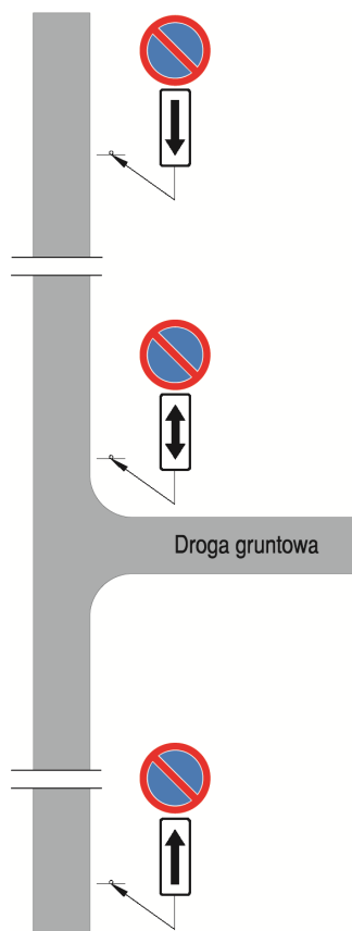
Rys. 3.2.36.6. Zastosowanie tabliczek T-25a, T-25b, T-25c
