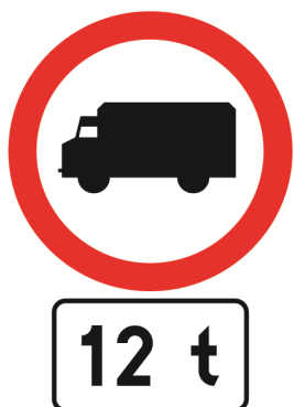
Rys. 3.2.6.3. Znak B-5 z tabliczką podającą masę pojazdu
