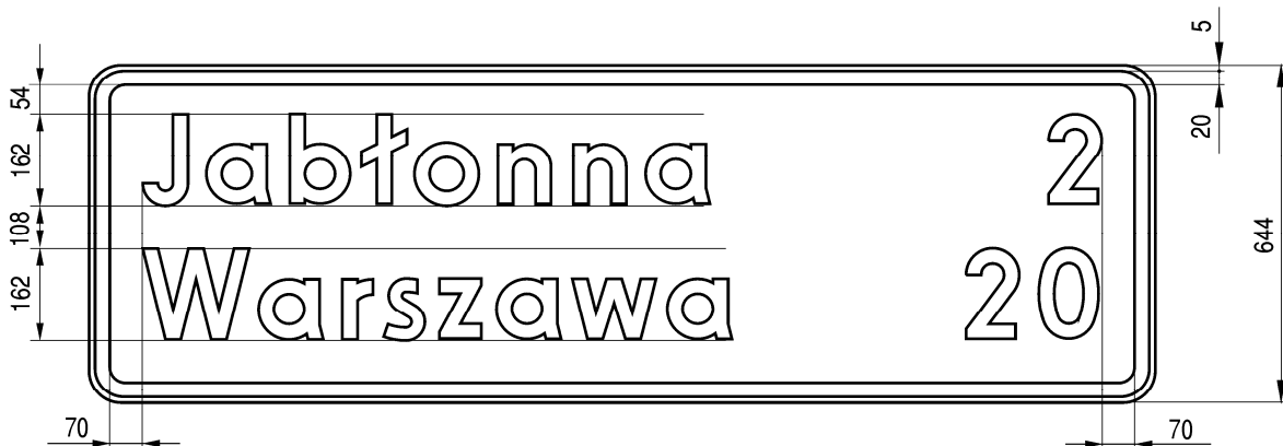
Rys. 9.5.43. Konstrukcja znaku E-13
