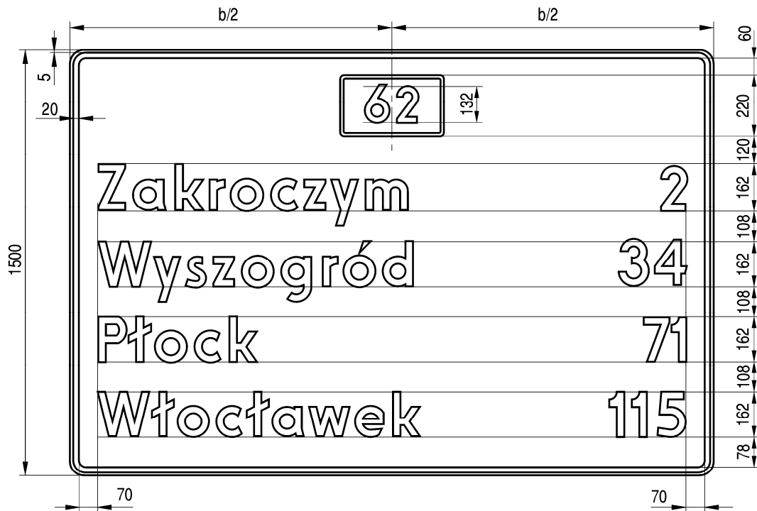
Rys. 9.5.44. Konstrukcja znaku E-14
