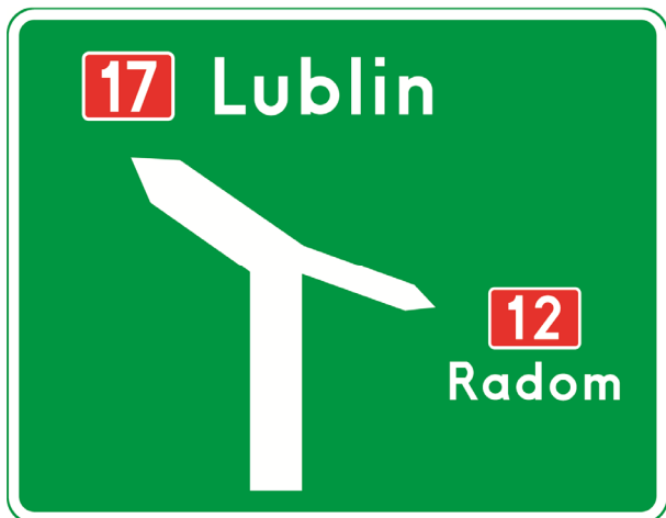
Rys. 6.3.1.3. Tablica E-1 przed trzyramiennym skrzyżowaniem dróg krajowych
