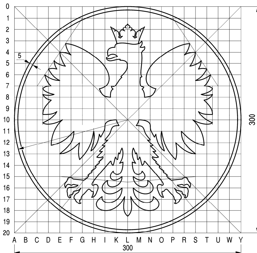
Rys. 9.6.3. 74) Szablon orła do znaków F-1, F-2 i F-2a
