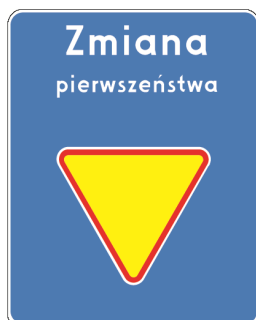
Rys. 5.2.54.2. Znak D-48 wskazujący wlot podporządkowany
