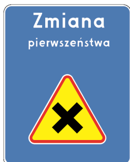
Rys. 5.2.54.1. Znak D-48 wskazujący skrzyżowanie dróg równorzędnych
