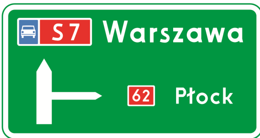
Rys. 6.3.1.7. Tablica E-1 na początku drogi ekspresowej
