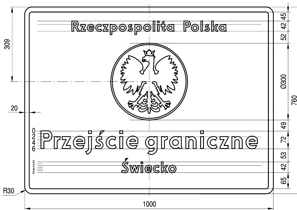
Rys. 9.6.1. Konstrukcja znaku F-1
