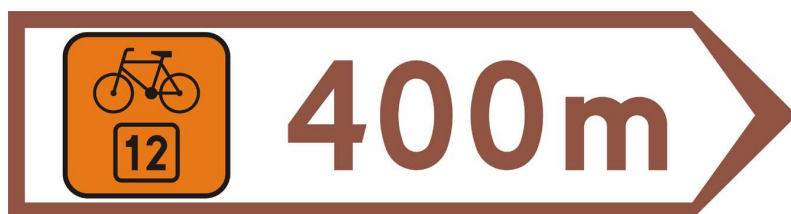
Rys. 8.2.7. Przykład połączenia znaku R-4 ze znakiem E-12a
