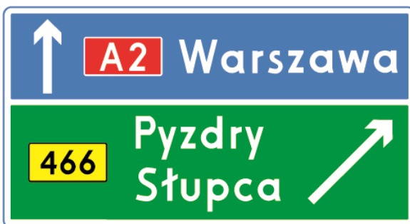
Rys. 6.3.2.5. Drogowskaz E-2c na autostradzie
