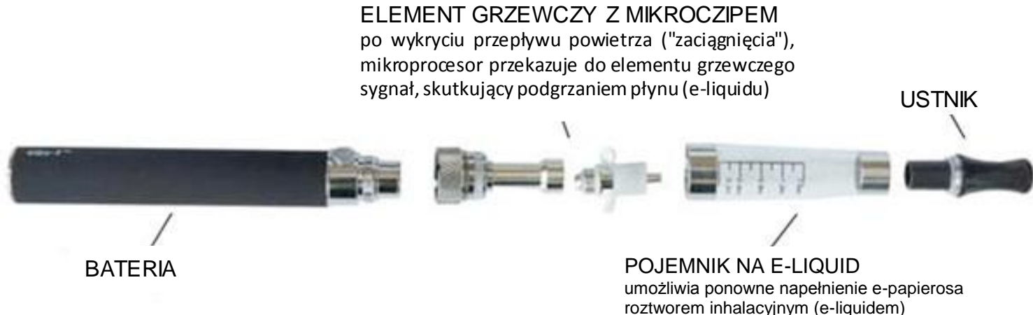
Rycina 1. Schemat budowy e-papierosa
