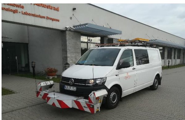
Fotografia 2. Profilograf laserowy RSP wykorzystywany do pomiaru równości nawierzchni
