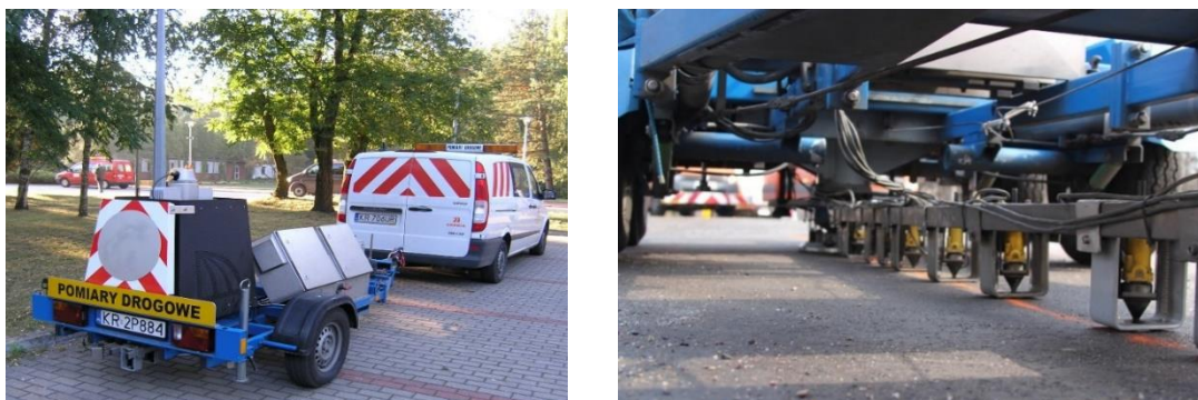
Fotografia 1. a) Zestaw pomiarowy FWD; b) Geofony pomiarowe oraz płyta naciskowa w urządzeniu
