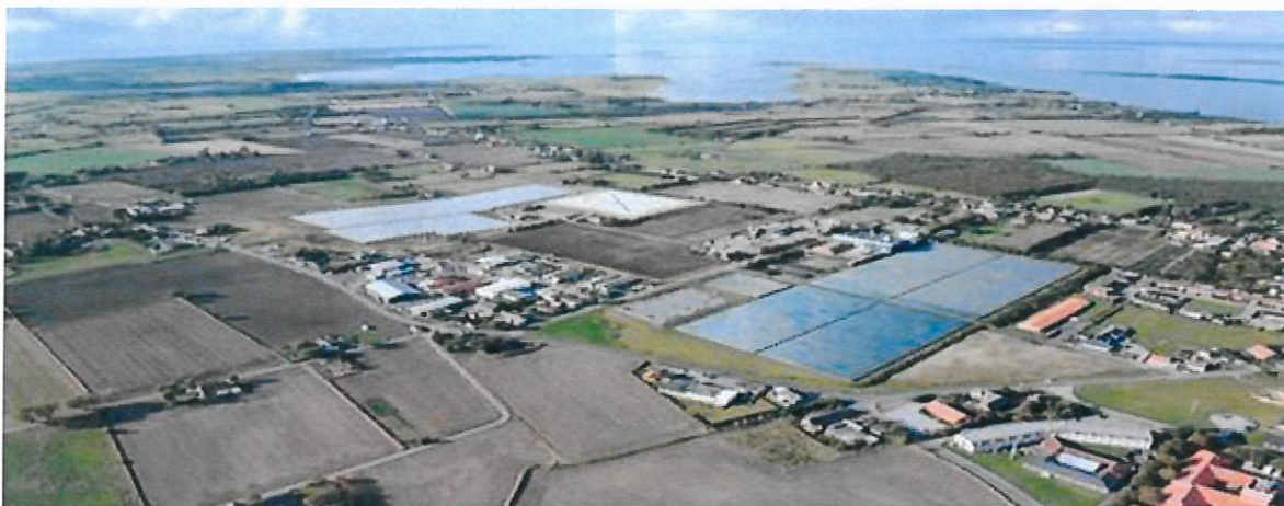
Rys. 2.3 Instalacja wielkowymiarowego systemu kolektorów słonecznych i sezonowego magazynu ciepła w Marstal. Źródło: www.solarmarstal.dk
