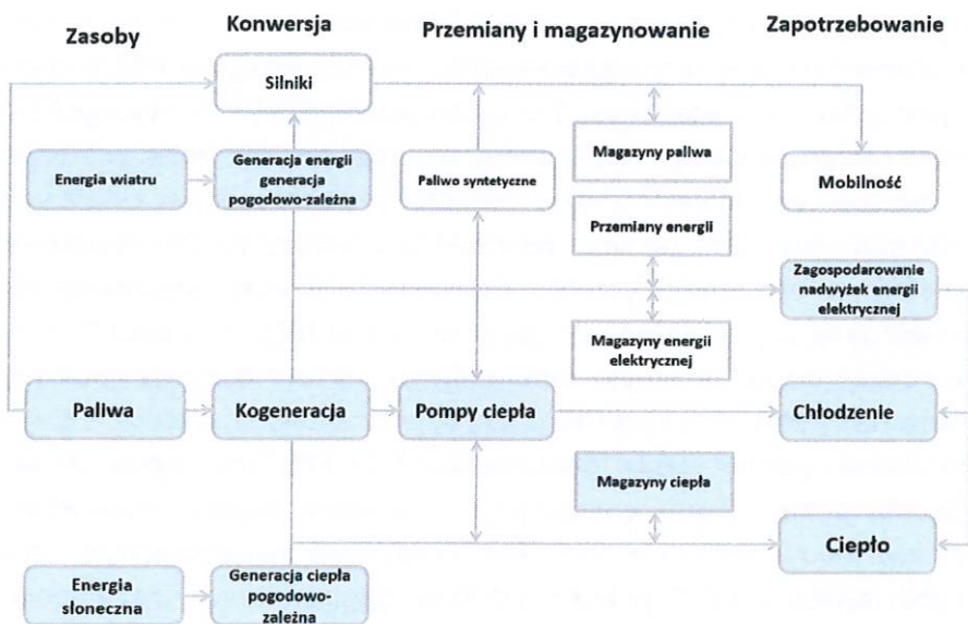
Rys. 1.16. Wprowadzanie nowych technologii i integracja ciepłownictwa z systemem energetycznym jako sposób na zwiększanie udziałów OZE w sposób zrównoważony środowiskowo: a) systemy tradycyjne I i II generacji, b) systemy zintegrowane III i IV generacji. Źródło: Projekt Heat Road Map Europe'2050 - Multi-level actions for enhanced Heating & Cooling plans", oprac. graficzne i adaptacja - IEO
